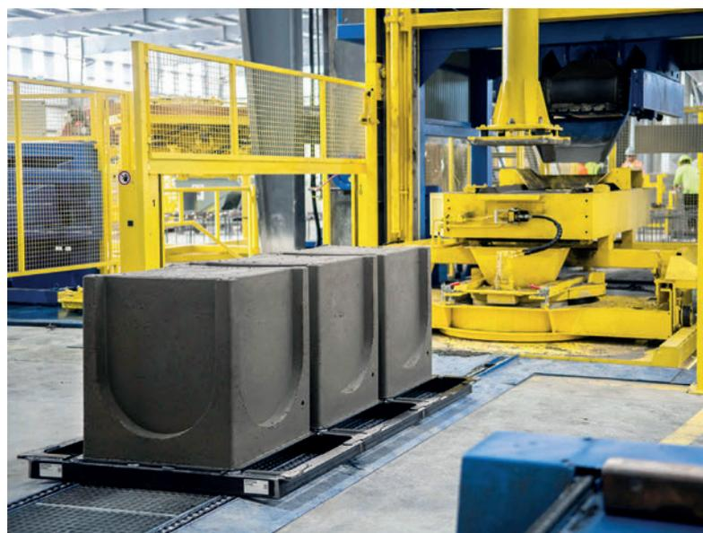
*Encofrados inferiores estables para bases para pozos rectangulares de desencofrado inmediato*
