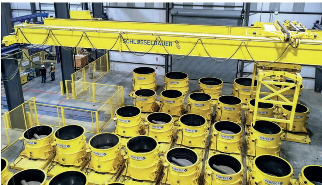
Producción de vaciado en húmedo automática para bases para pozos con diferentes geometrías
