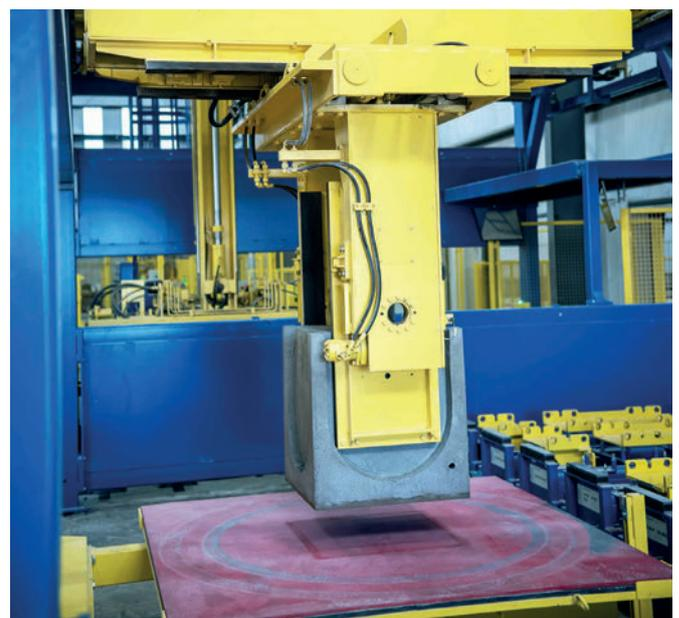
*Manipulación totalmente automática (sujeción, elevación, giro, depósito) de los productos en el sistema de paletización*
