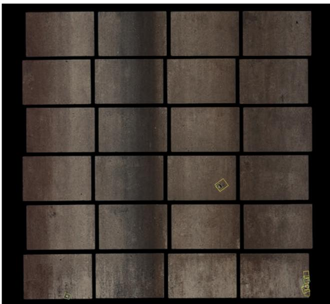
Imagen de resultado de defectos: Cada tipo de defecto recibe una marca de color diferente.
