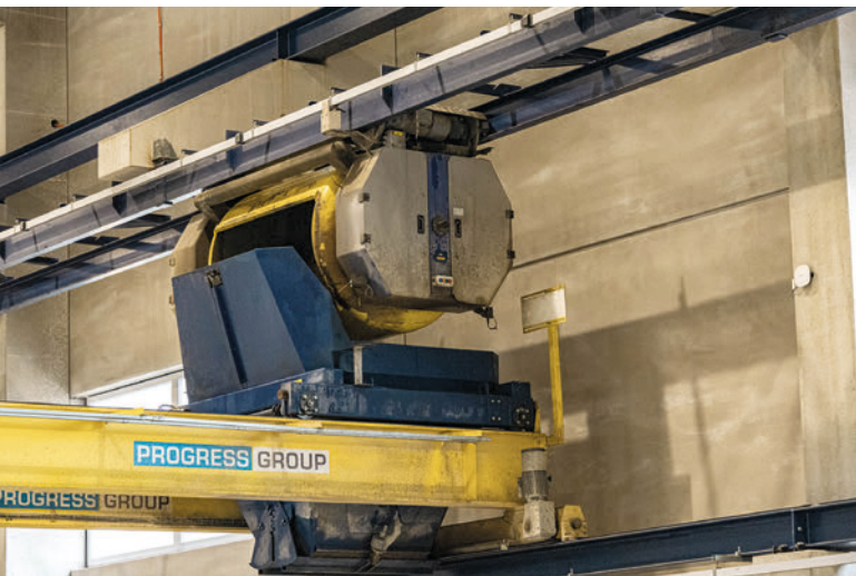
Der Betonverteiler mit Brücke ist für eine automatische Betonzufuhr von Frischbeton über eine Kübelbahn konstruiert.
