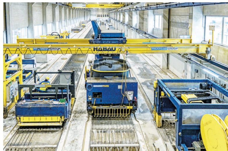
Die Bahnen von 2,40 m Breite machen verschiedenste Produkte möglich – so können zwei 1,20 m breite Decken parallel auf einer Bahn produziert werden.
