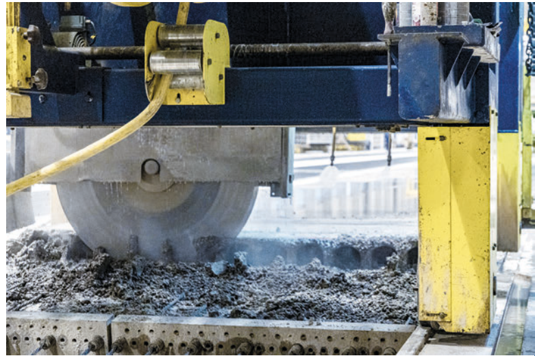
Die schienengeführte Sägemaschine produziert saubere, exakte Schnitte in ausgehärteten Betonelementen sowie Frischbeton.
