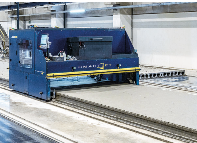
Der Plotter SmartJet ist neben der Druckvorrichtung mit einer zusätzlichen Bohreinrichtung ausgestattet.
