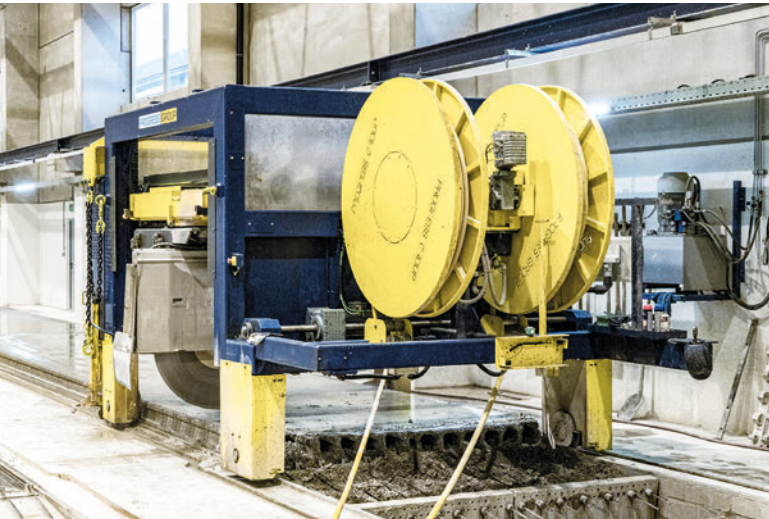
Die schienengeführte Sägemaschine produziert saubere, exakte Schnitte in ausgehärteten Betonelementen sowie Frischbeton.
