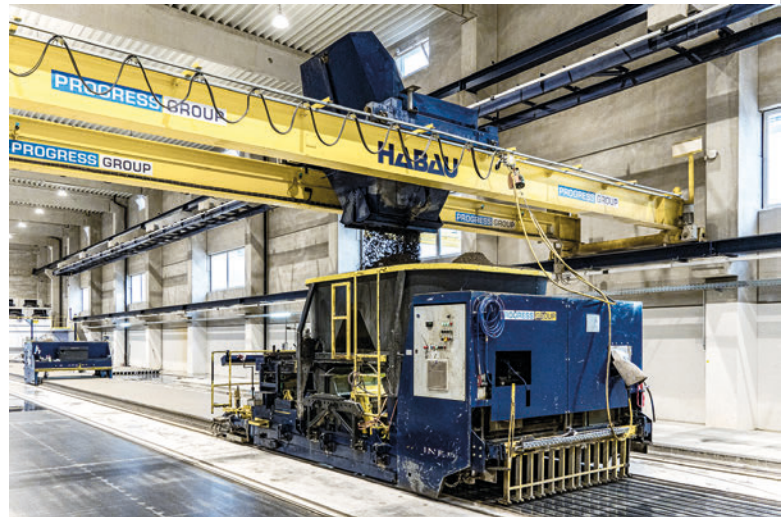
Der Gleitfertiger S-Liner® gilt dank seiner spezifischen Konstruktion und dem Einsatz von erdfeuchtem Beton als kosteneffizient, bedienungs- und wartungsfreundlich.
