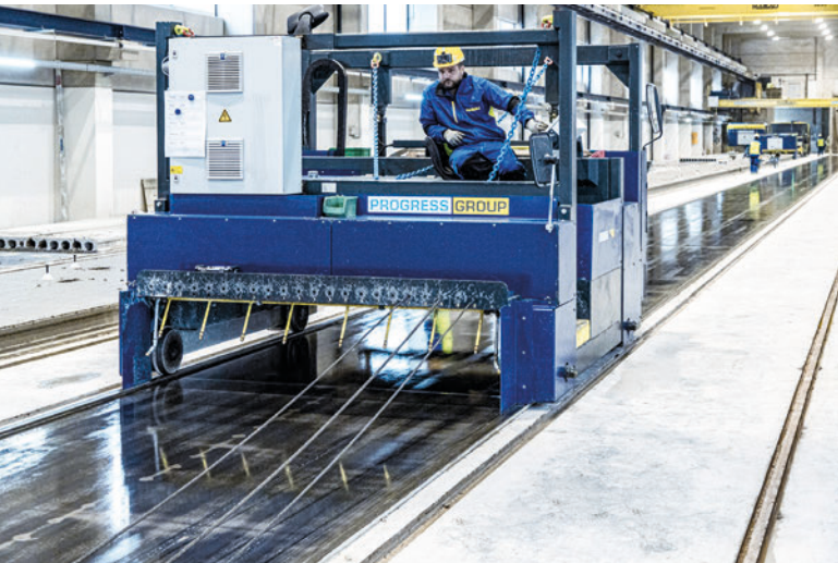
Der batteriebetriebene Multifunktionswagen wird für die Einrichtung einer (neuen) Bahn eingesetzt: zum Reinigen, Ölen und Ziehen der Litzen/Drähte.
