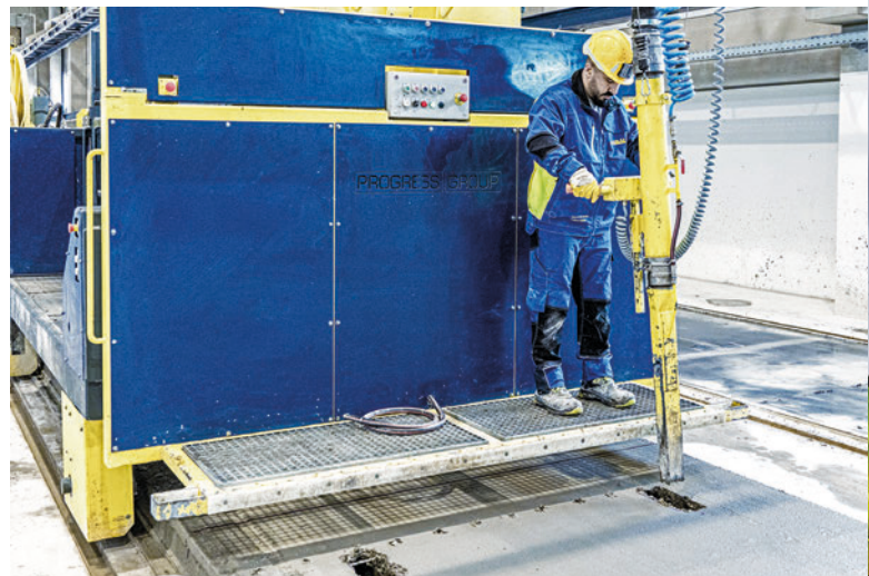
Die Betonabsaugmaschine wird in erster Linie zur Entfernung des Betons bei Aussparungen und Öffnungen eingesetzt.
