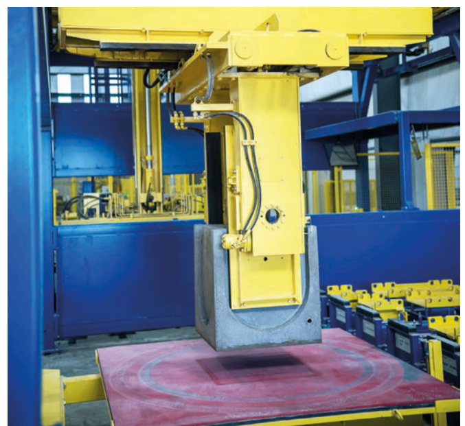
Vollautomatische Manipulation (Greifen, Heben, Wenden, Ablegen) der Produkte in der Palettieranlage
