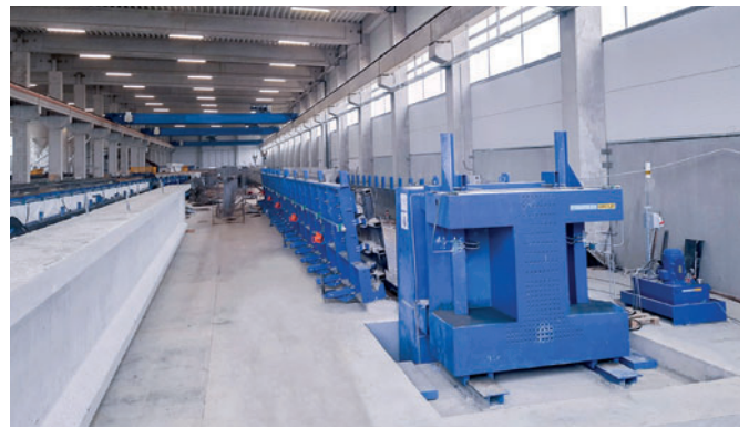
Опалубка для балок с упорами облегчает производство по индивидуальному заказу
