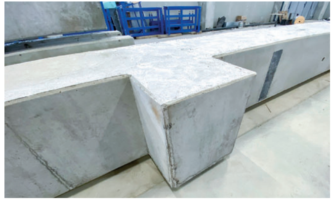
Опоры с несколькими консолями на каждой стороне не проблема для универсальных установок «ГБС Прифаб»
