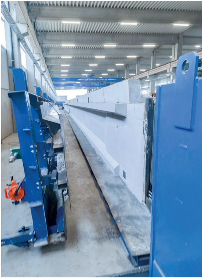
Опоры с несколькими консолями на каждой стороне не проблема для универсальных установок «ГБС Прифаб»
