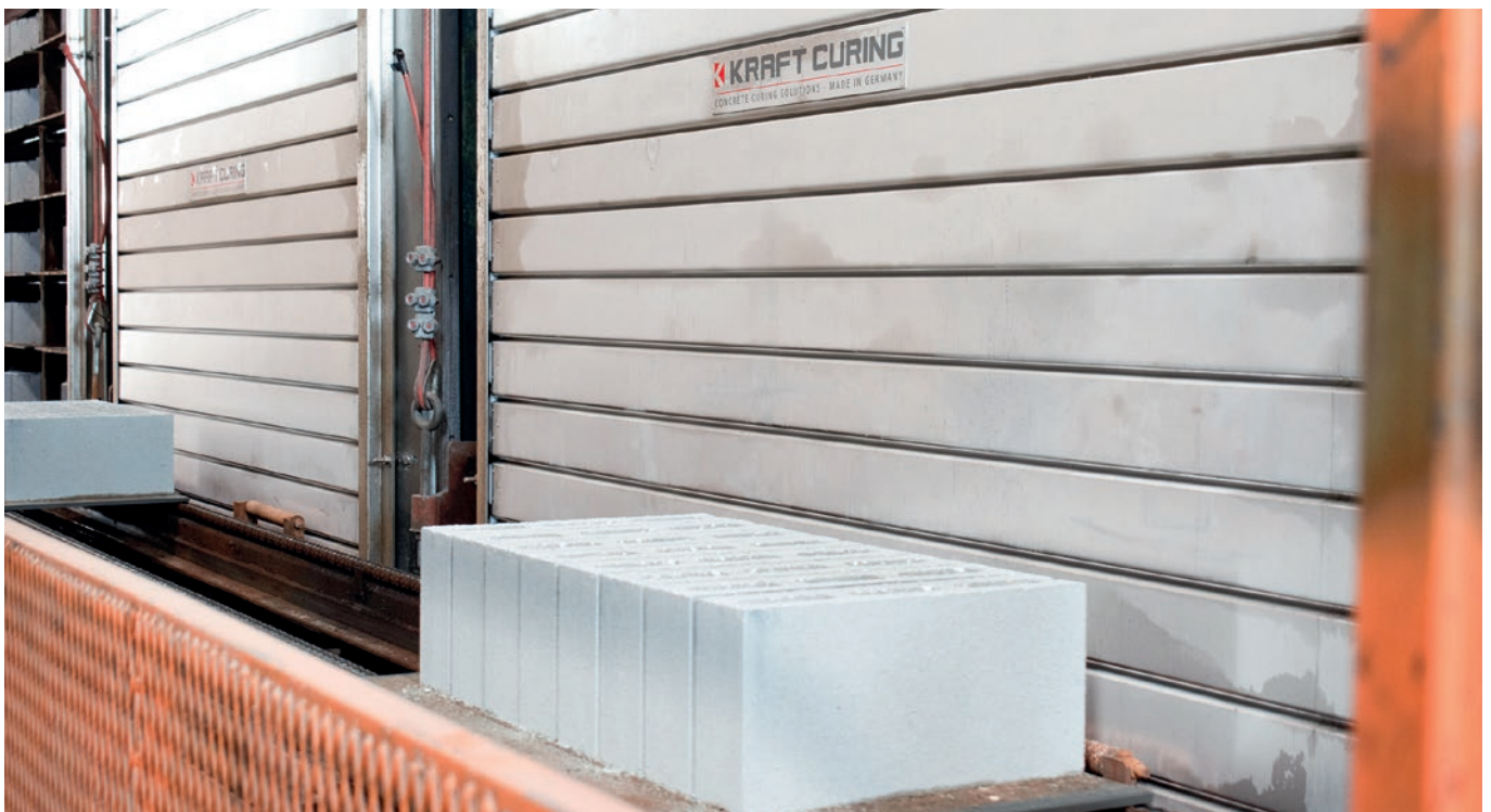
Stwardniałe bloczki betonowe na przenośniku taśmowym systemu ABC.
