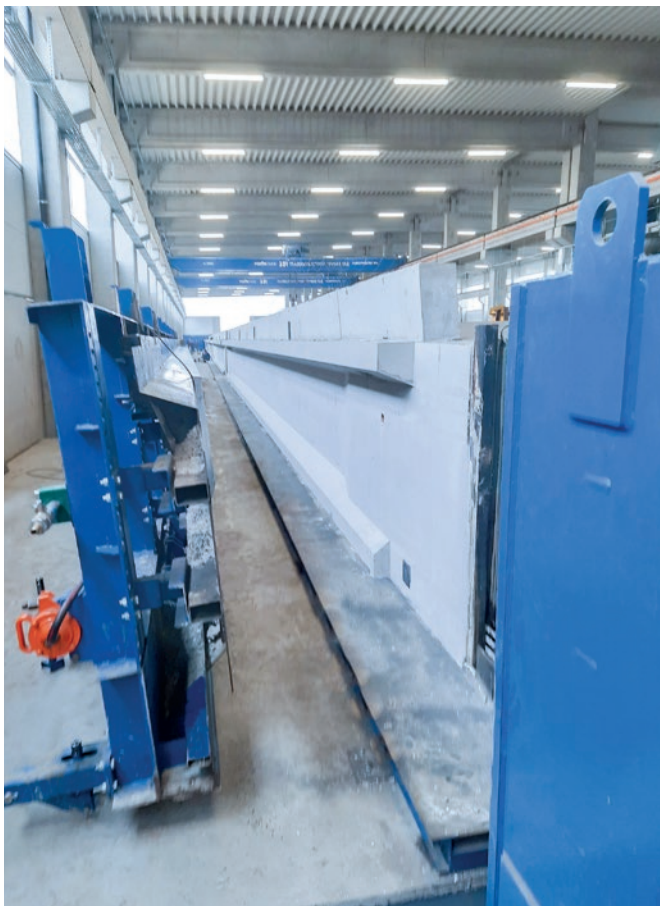
Uniwersalna forma do produkcji belek dwuteowych ma 32 metry długości i umożliwia wytwarzanie wysokiej jakości belek dla średnich i dużych budynków przemysłowych.
