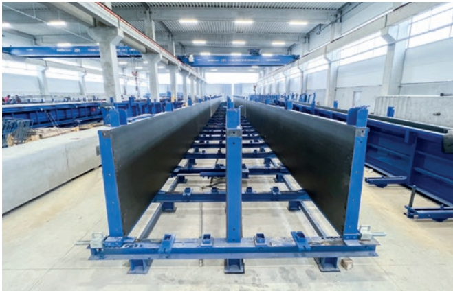
Forma bateryjna do produkcji słupów pozwala osiągnąć bardzo wysoką wydajność na dostępnej przestrzeni.
