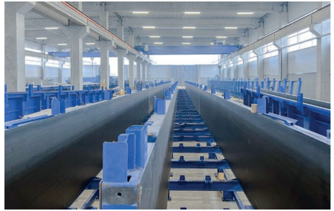
Formy zapewniają wysoką jakość powierzchni i szybką produkcję prefabrykowanych słupów.
