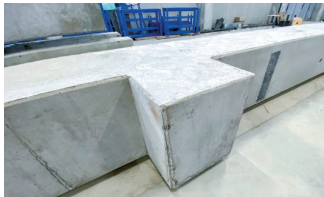
Nawet słupy z kilkoma wspornikami z każdej strony nie stanowią problemu dla uniwersalnych maszyn GBS Prefab.
