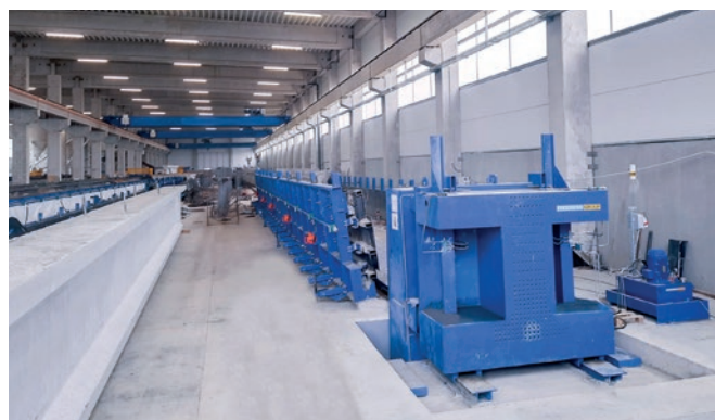
Forma z blokami kotwiącymi ułatwia produkcję płyt dostosowanych do potrzeb klienta.
