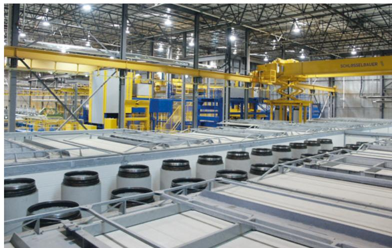
*Produzione completamente automatizzata di tubi in calcestruzzo Exact 2500 con l'uso di fondelli superiori in acciaio per giunzioni precise e a tenuta.*
