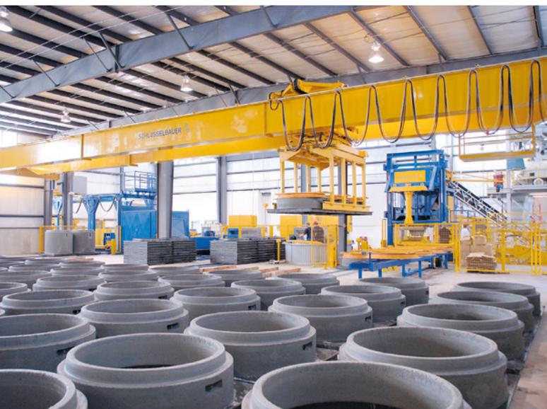
*In molti impianti per la produzione di componenti per pozzetti, la gru automatica garantisce una maggiore efficienza produttiva.*
