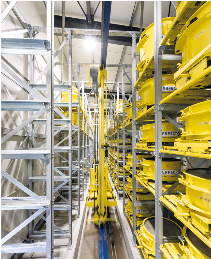
Um Industriehallen optimal zu nutzen, werden neben Kränen immer häufiger Regalsysteme als Aushärtezonen eingerichtet.
