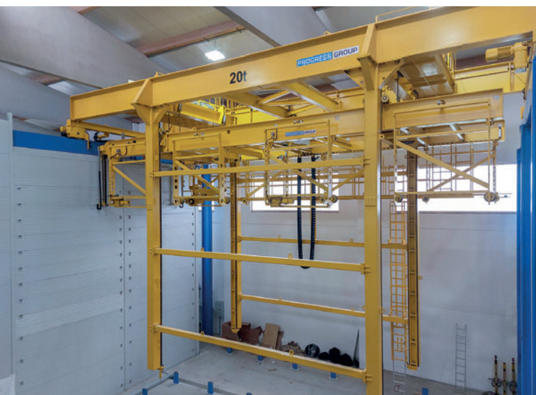
Подъемно-опускной штабелер закладывает поддоны со свежесформованными изделиями в камеру выдержки для эффективного набора прочности
