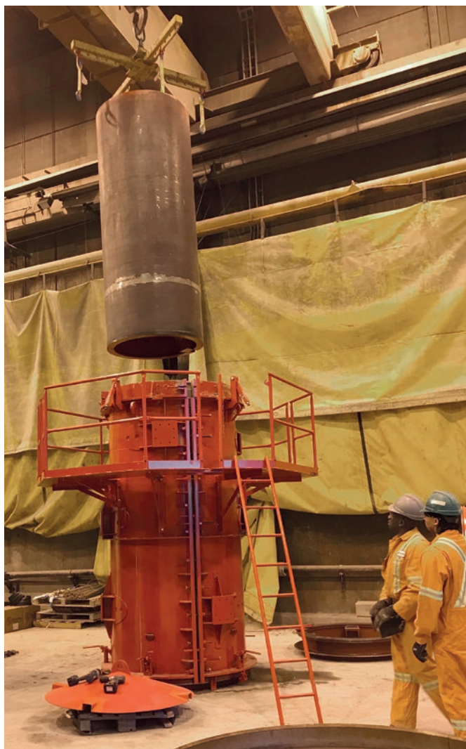
Początek procesu rozformowywania – wyjmowanie rdzenia formy.
