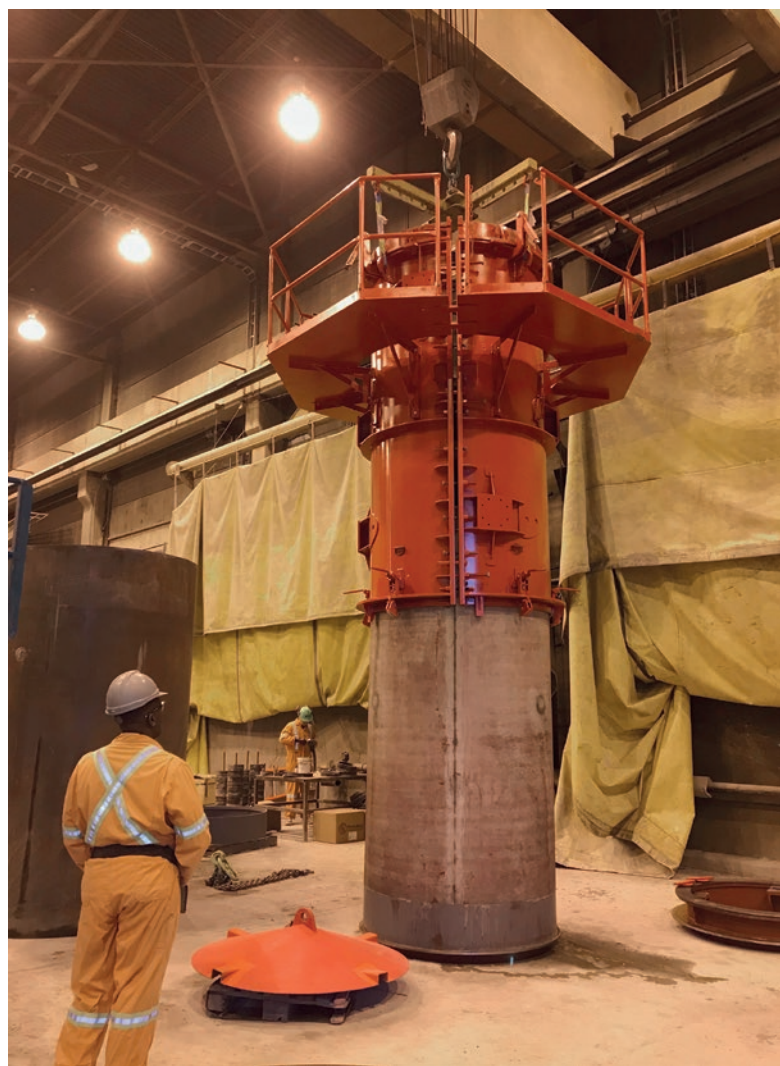
Zdejmowanie płaszcza – stwardniała rura precyzyjna na podkładzie.
