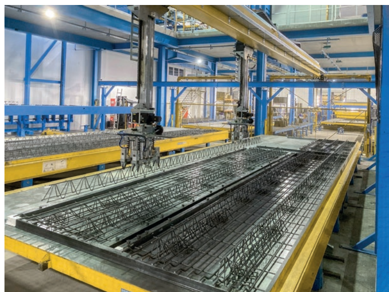
Dzięki elastycznym rozwiązaniom logistycznym, takim jak robot układający, zbrojenie może być transportowane i układane bez ciężkiej pracy fizycznej.
