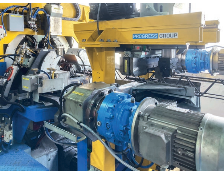
Zgrzewarka kratownic Versa może w trakcie bieżącej produkcji w ciągu kilku sekund przełączyć się na inną wysokość kratownicy.
