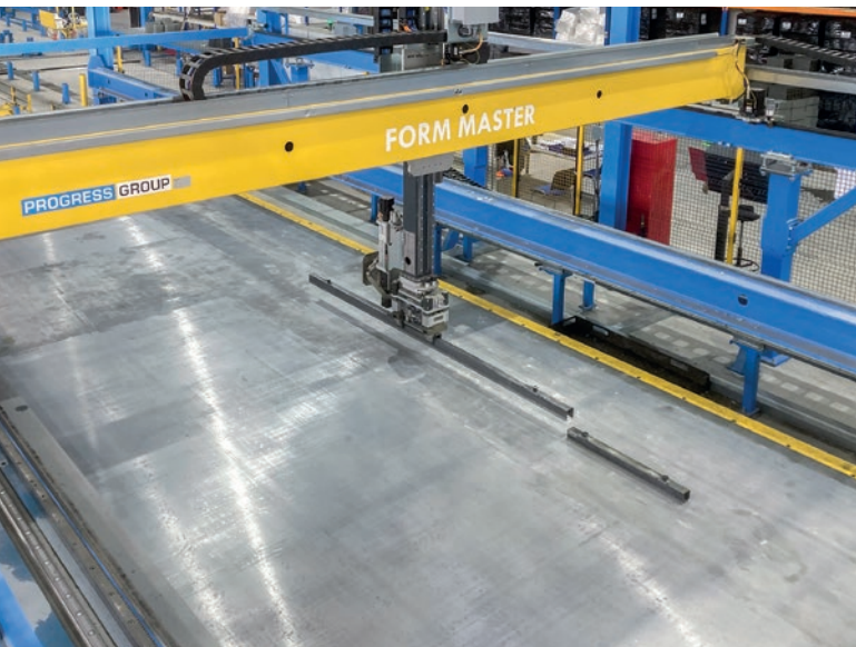
Robot szalunkowy Form Master układa szalunki w pełni automatycznie zgodnie z danymi CAD.
