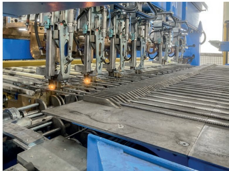
Zgrzewarka M-System BlueMesh® w pełni automatycznie i w krótkim czasie produkuje siatki i kosze zbrojeniowe ze stali podawanej z kręgów.
