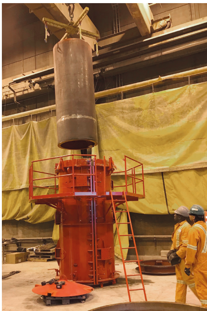
Inizio del processo di disarmo - Prelievo dell'anima dello stampo
