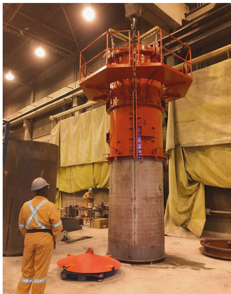
Disarmo del rivestimento dello stampo - Tubo a spinta stagionato sul fondo
