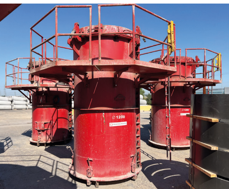
Attrezzature fornite per stampi di varie dimensioni per la produzione di tubi a spinta stagionati in casseri
