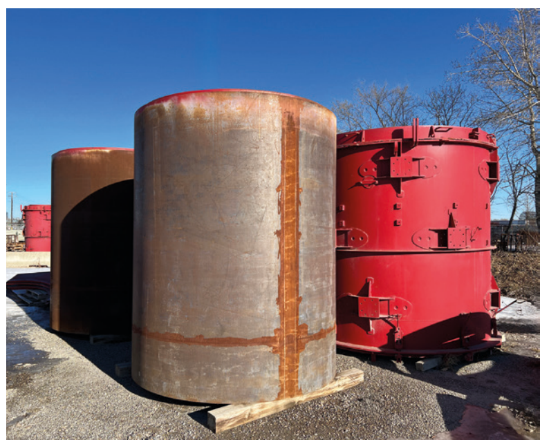
Attrezzature fornite per stampi di varie dimensioni per la produzione di tubi a spinta stagionati in casseri
