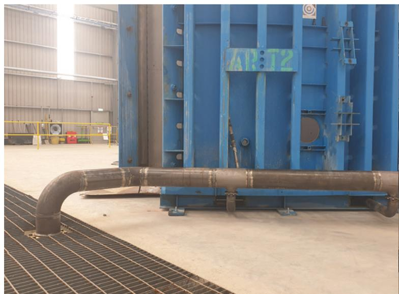
*Stagionatura primaria nel sito di produzione finale - le trincee per le tubazioni mantengono il pavimento libero da ostacoli. Il vapore viene sempre erogato a livello del pavimento, direttamente sotto lo stampo, per garantire una stabilità ottimale della temperatura.*
