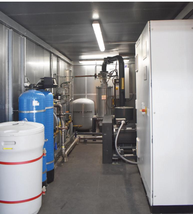
L'unità di stagionatura a vapore in container con sistema di trattamento dell'acqua
