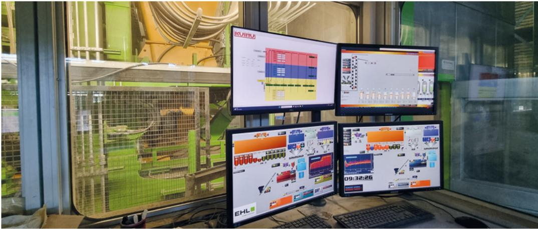
Commande centrale de l'installation de dosage et de mélange via le système de pilotage des processus Sauter s-mix.
