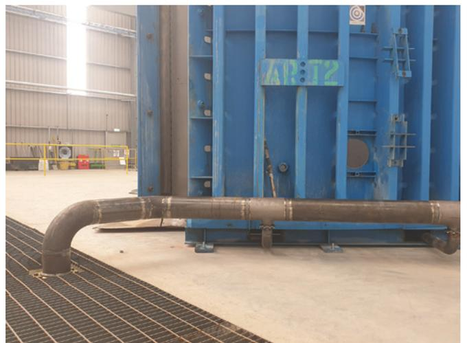
*Cycle de cure primaire dans le hall de production; des tranchées ont été aménagées pour les tuyaux, permettant une circulation sans encombre dans l'usine. La vapeur est délivrée au niveau du sol, directement sous le moule, afin d'assurer une température homogène sur tout l'élément en béton.*
