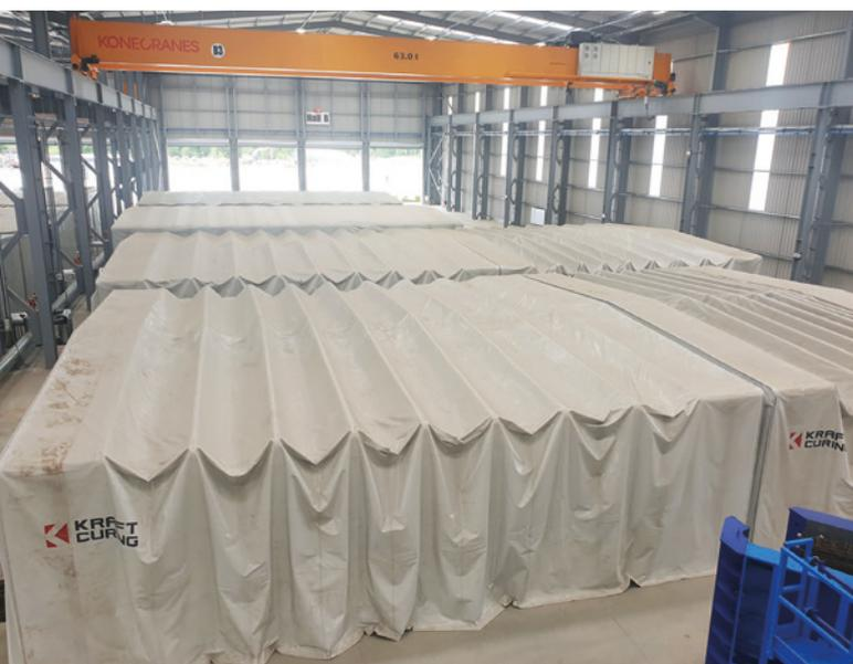
Quelques-unes des enceintes pliables situées dans la zone de cure secondaire. Chaque enceinte peut contenir deux éléments en béton.
