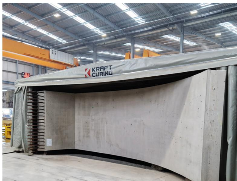
Les tentes réduisent les besoins en main d'œuvre, permettant de recouvrir rapidement deux éléments pour le cycle de cure secondaire.
