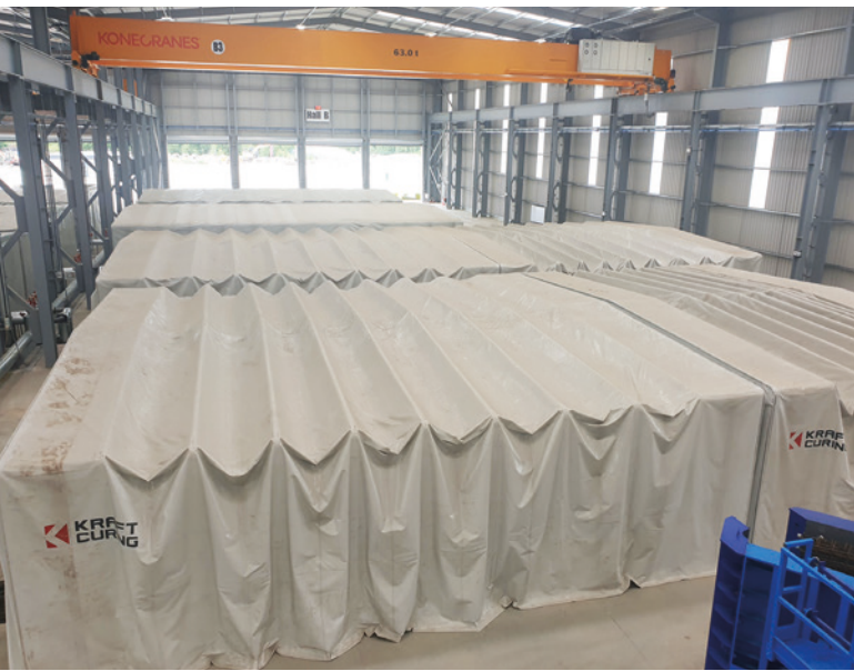
Algunos de los cerramientos retráctiles en la zona del curado secundario. Cada cerramiento puede albergar 2 elementos de hormigón.
