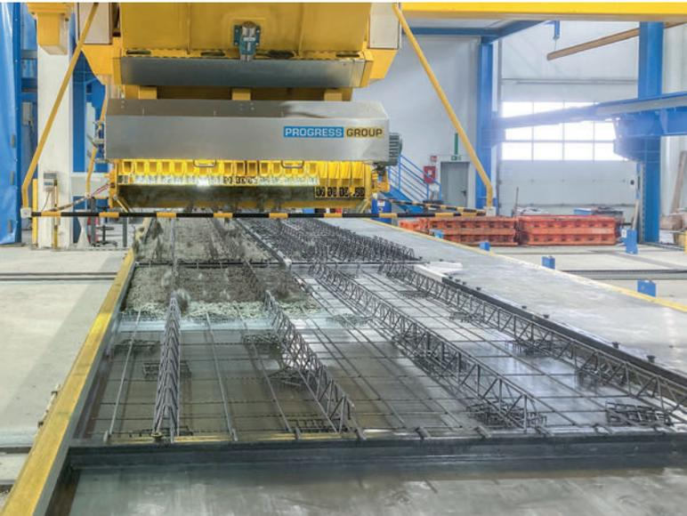
*Der Betonverteiler eCon Drive® arbeitet nur mit dem effektiv benötigten Beton und sorgt so für ein hochwertiges Produkt bei gleichzeitiger Materialersparnis.*
