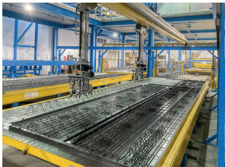
Mit flexiblen Logistiklösungen wie dem Verlegeroboter kann die Bewehrung nun ohne schwere körperliche Arbeit transportiert und eingelegt werden.
