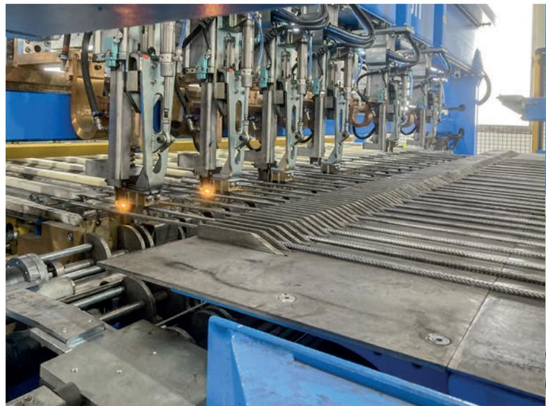
Mit der Mattenschweißanlage M-System BlueMesh® können Matten und Körbe in kurzer Zeit vollautomatisch vom Coil produziert werden.
