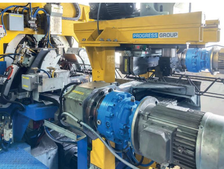
Die Gitterträgerschweißanlage Versa kann bei laufender Produktion innerhalb weniger Sekunden auf eine andere Gitterträgerhöhe umstellen.
