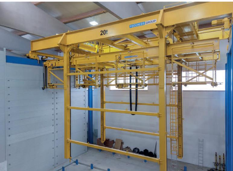
Das Regalbediengerät lagert die Paletten mit den frisch betonierten Elementen in die Trockenkammer ein, wodurch nun ein effizientes Aushärten der Betonfertigteile ermöglicht wird.
