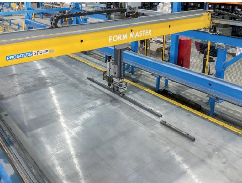
Der Form Master Schalungsroboter verlegt die Schalungen genau nach CAD-Plan vollautomatisch.
