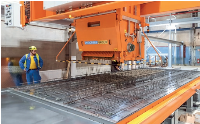
Rozścielacz mieszanki betonowej eCon Drive umożliwia betonownie z prędkością 5 podkładów na godzinę przy 28 m 2 betonu na podkład.
