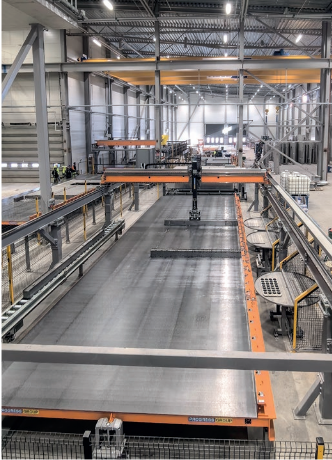
Robot szalunkowy Form Master automatycznie rozmieszcza nawet najmniejsze elementy potrzebne w formie.
