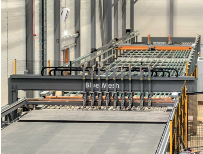
Zgrzewarka M-System zgrzewa, zagina i formuje stal w specjalne kosze zbrojeniowe.
