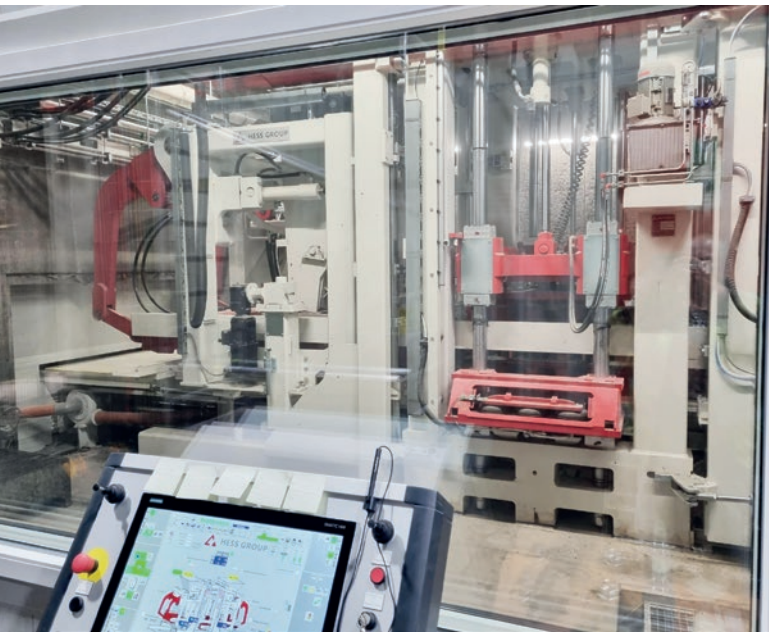
Panel sterowania i wibroprasa RH 2000-4 MVA (Hengelo).
