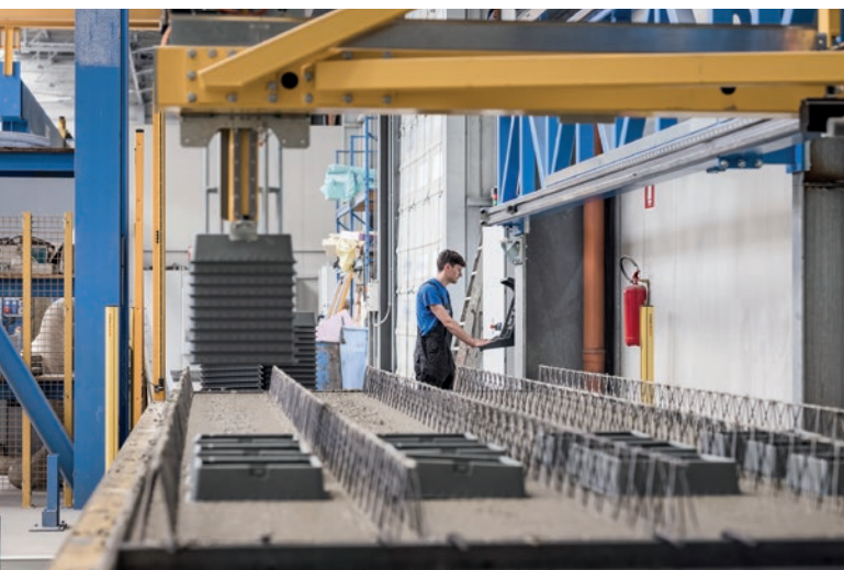
Box Master umieszcza dolną połowę skrzynki GC (GC base) w pełni automatycznie w Green Code Eco Slab®. Na budowie podstawa jest zakrywana pokrywą (GC top), stanowiącą drugą połowę skrzynki.
