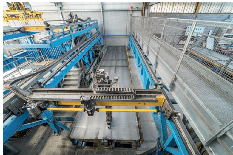
Robot szalunkowy Form Master precyzyjnie rozmieszcza elementy szalunku zgodnie z danymi CAD przesyłanymi przez system sterowania ebos®.
