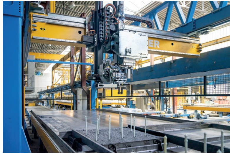
Pin Master automatycznie wprowadza szpilki GC bezpośrednio przez materiał izolacyjny do jeszcze niestwardniałego betonu, eliminując konieczność ręcznego rozmieszczania szpilek.
