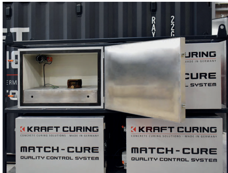
I quattro forni Match-Cure sono collocati accanto al generatore di vapore containerizzato
