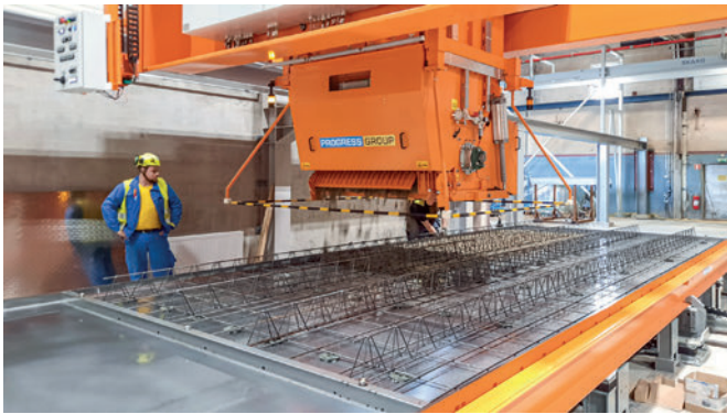
Il distributore di calcestruzzo eCon Drive nello stabilimento di Ucklum è in grado di produrre 5 pallet all'ora con 28 m 2 per ogni pallet.
