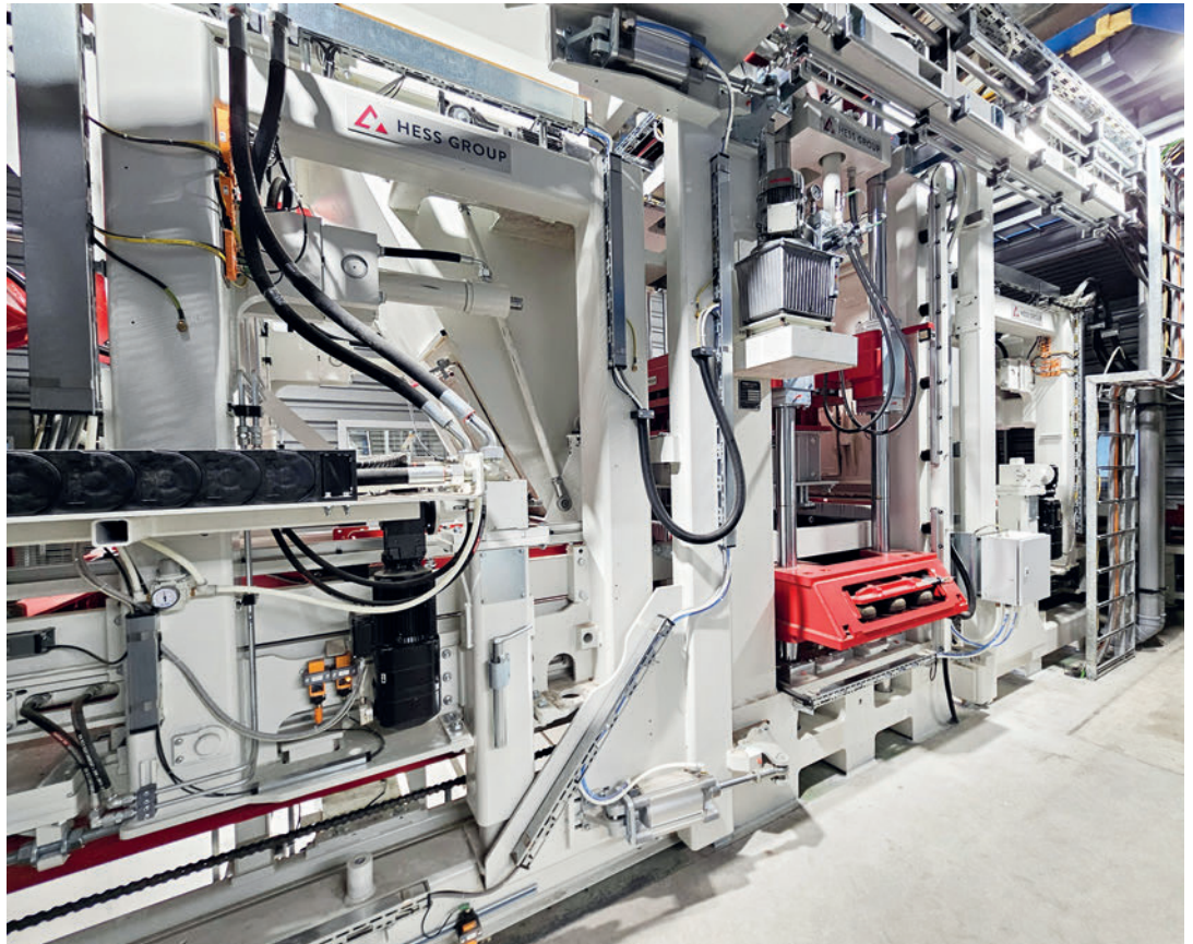
La presse RH 1500-4 MVA à l'usine de Hardenberg
