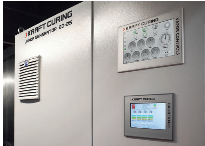
L'armoire de commande de l'unité conteneurisée avec le panneau tactile Vapor Controls (en haut à droite) et le panneau tactile AutoCure en dessous
