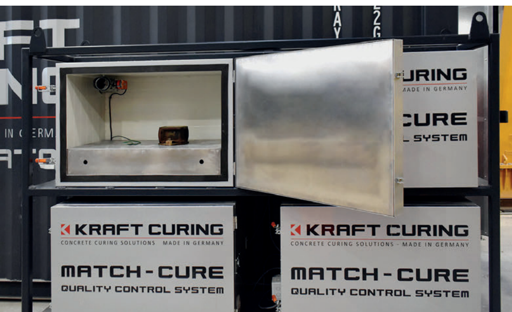
Les quatre étuves MatchCure disposées à côté du générateur de vapeur conteneurisé
