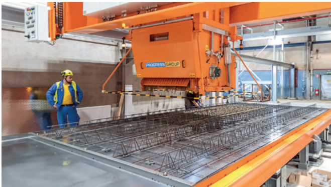
Le distributeur de béton eCon Drive de l'usine d'Ucklum peut produire 5 palettes par heure avec 28 m 2 par palette.
