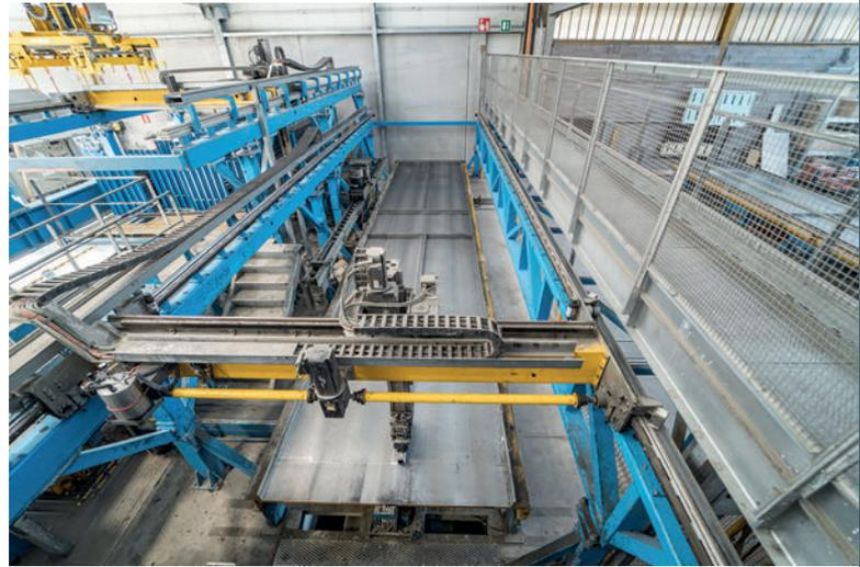
El robot de encofrado y desencofrado Form Master puede ubicar los encofrados de forma precisa en función de los datos CAD recibidos del sistema de control ebos®.
