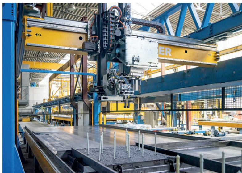
*El Pin Master coloca los GC pins directa y automáticamente a través del material aislante en el hormigón fresco, evitando tener que colocarlos manualmente.*
