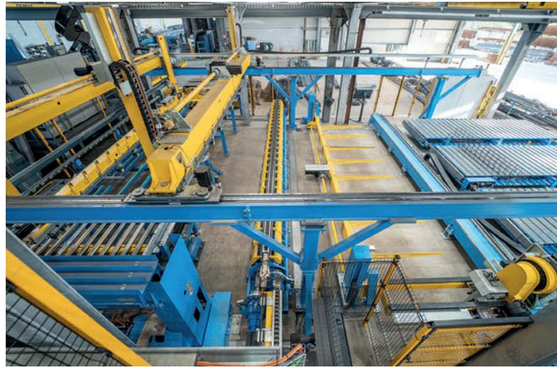
*La máquina soldadora de mallas M-System Smart Mesh está equipada con una plegadora adicional, que facilita la producción completamente automática de jaulas.*
