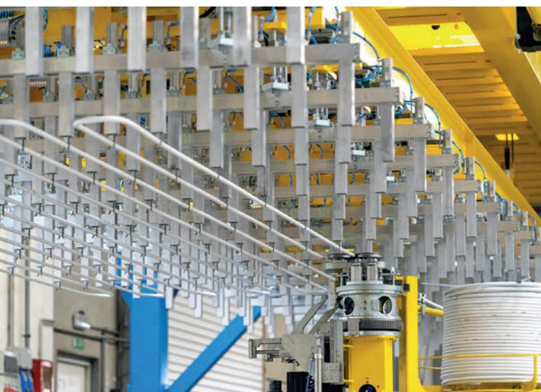
*El robot colocador de tubos Tube Master es una novedad en el mercado. Coloca tubos de calefacción y refrigeración de forma completamente automática en las losas prefabricadas correspondientes.*
