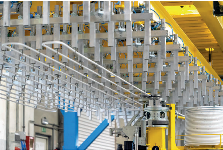
Der Tube-Master-Rohrverlegeroboter ist eine Markneuheit. Er verlegt Heiz- und Kühlrohre vollautomatisch in die dafür vorgesehenen Fertigteildecken.
