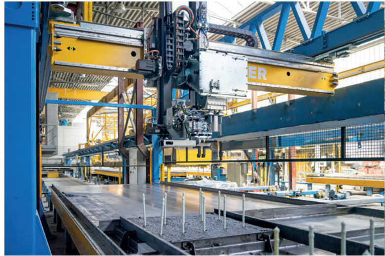
Der Pin Master setzt die GC pins automatisch direkt durch das Dämmmaterial in den frischen Beton und ersetzt so das Einfügen dieser von Hand.
