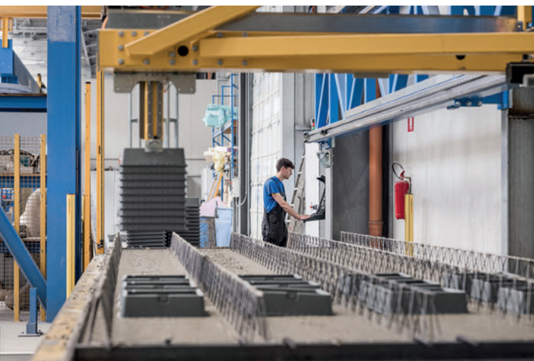
Der Box Master verlegt die untere Hälfte der GC box (die GC base) vollautomatisch im Werk in die Green Code Eco Slab® - diese wird dann auf der Baustelle mit dem GC top vervollständigt.
