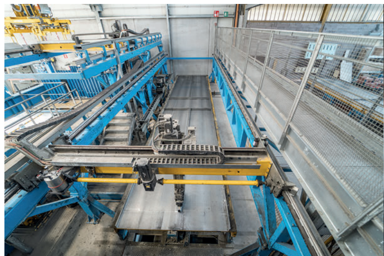
Der Form-Master-Schalungs- und Entschalroboter kann entsprechend der vom Leitsystem ebos® übermittelten CAD-Daten die Schalungen maßgenau positionieren.
