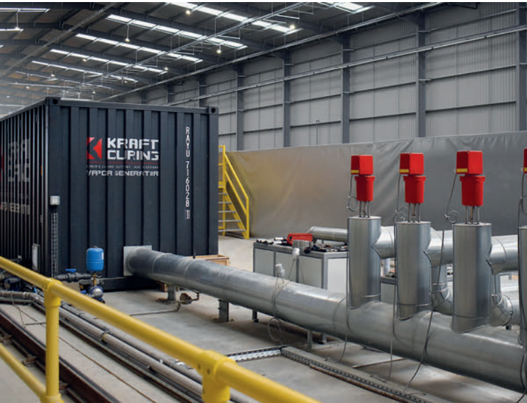
Die containerisierte Vapor-Generator-Einheit mit 4 automatischen Vapor-Ventilen
