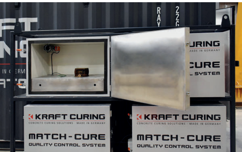
Die vier Match-Cure-Öfen befinden sich neben dem containerisierten Vapor Generator.
