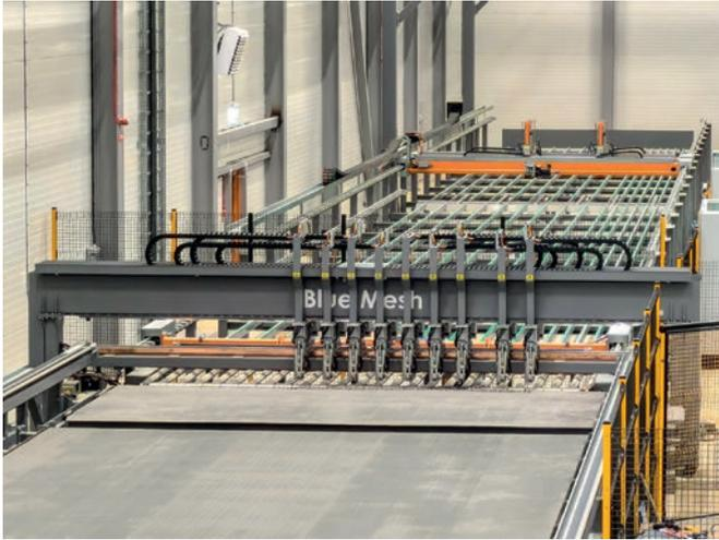
Die Mattenschweißanlage M-System schweißt, biegt aber auch den Stahl und formt ihn zu den benötigten Spezialelementen.
