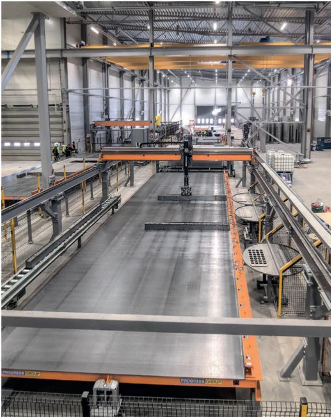
Der Form-Master-Schalungs- und Entschalroboter baut sogar die benötigten Kleinteile vollautomatisch in die Schalung ein.
