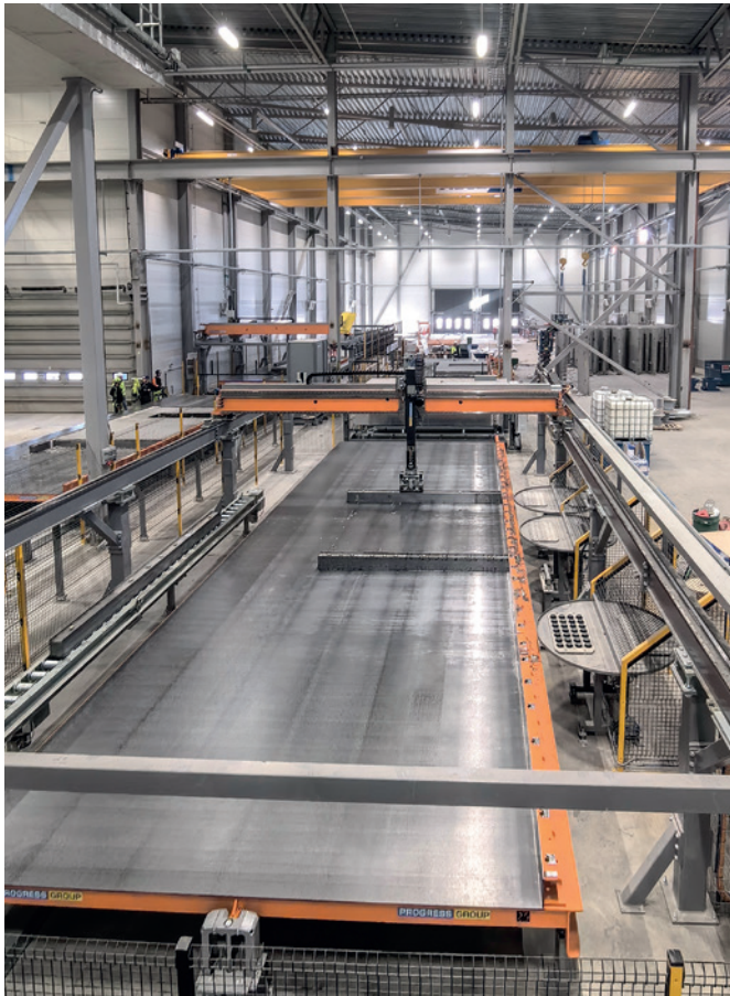
Form Master 模板和拆模机器人甚至可以全自动地将所需的小零件装入模板中
