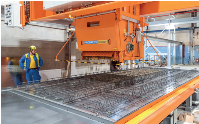
Ucklum 工厂的 eCon Drive 混凝土分配器每小时可以生产 5 个托盘，每个托盘 28 平方米
