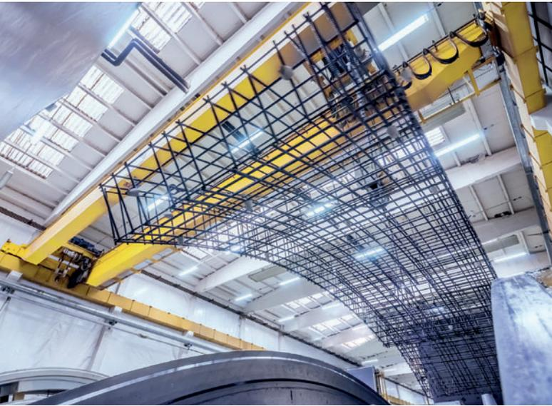
Полноценные арматурные каркасы для тоннельных сегментов выпускаются в полностью автоматическом режиме на станках группы Progress
