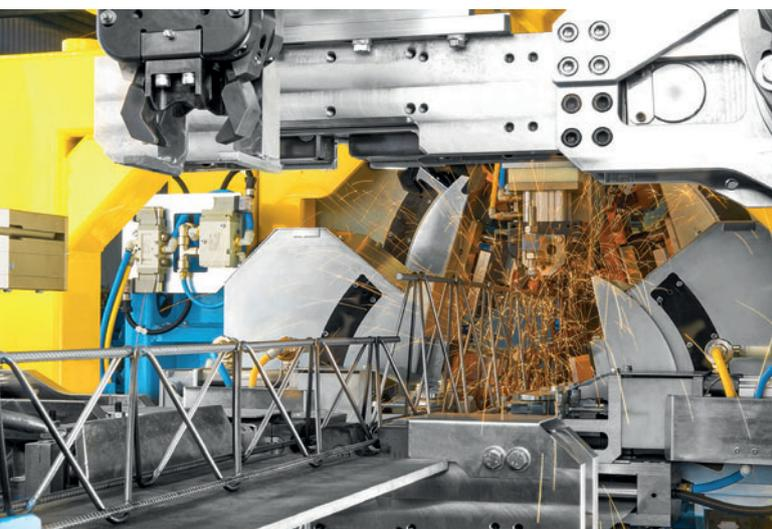
Система сварки решетчатых балок Versa обеспечивает гибкое производство решетчатых балок с бухты в режиме «точно в срок» с автоматическим изменением высоты
