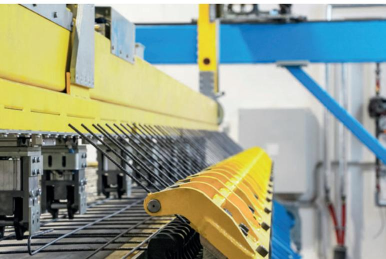
Полностью интегрированная гибочная система облегчает обработку арматурной сетки
