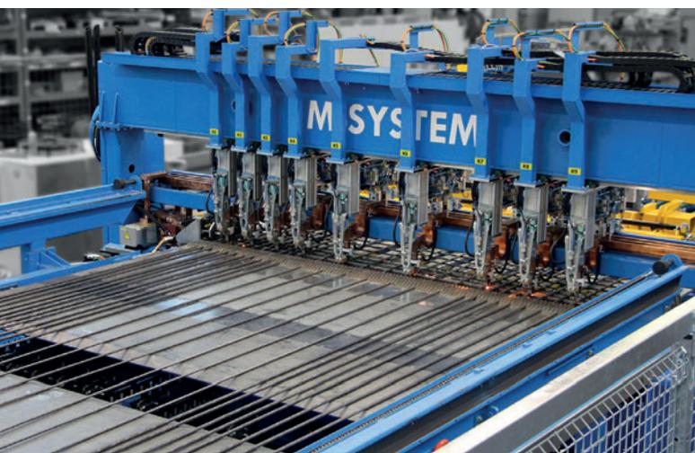
Сеткосварочная линия M-System обеспечивает автоматизированное производство арматурных сеток и каркасов
