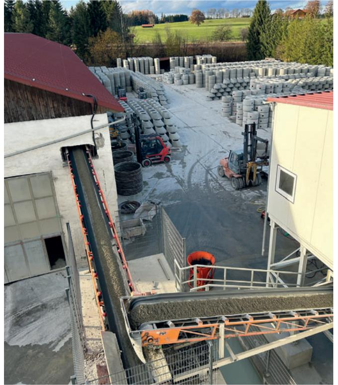
Жесткая бетонная смесь поступает по ленточным конвейерам прямо в производственный цех
