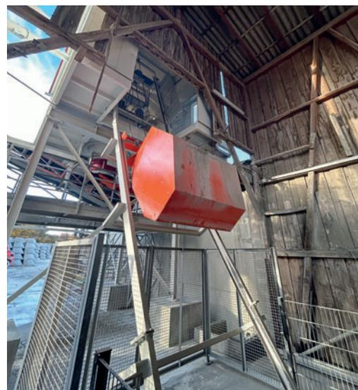
Дозирующие конвейеры под отдельными бункерами для заполнителей      Подъемник с защитой от падения
