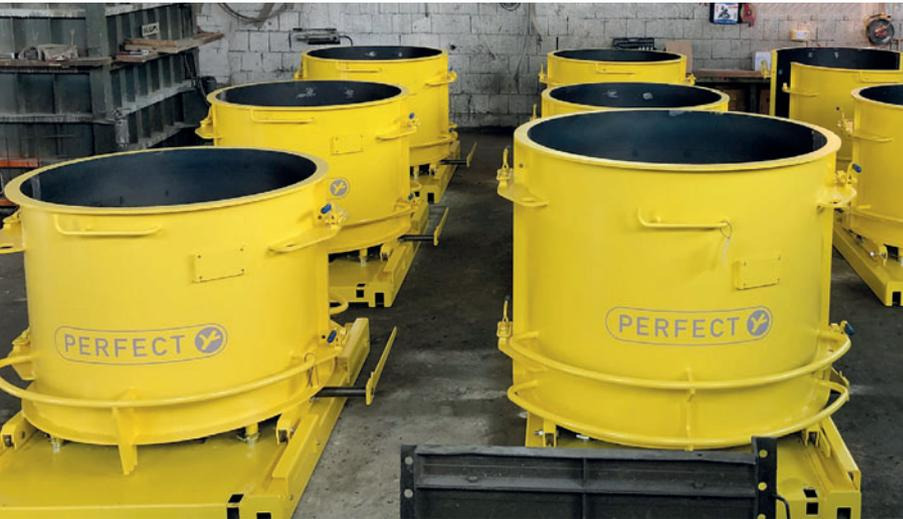
С 2019 года компания Wegmann производит монолитные основания для колец с днищем, используя технологию Perfect от Schlüsselbauer Technology
