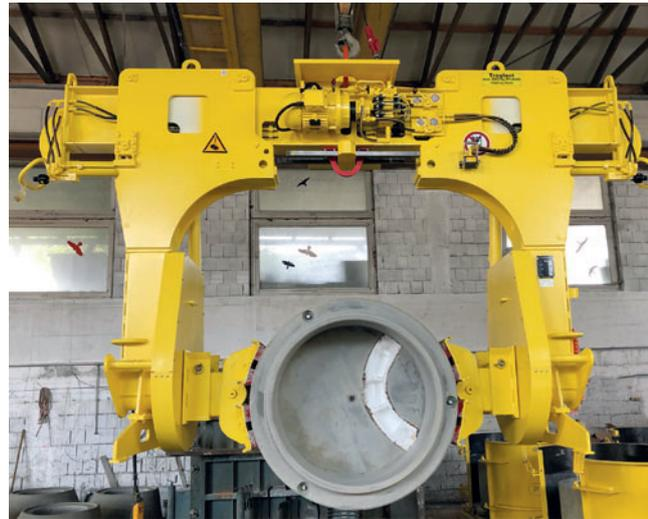
Для безопасного извлечения и поворота элементов используется гидравлический поворотный захват
