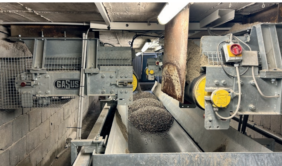
Dotychczasowe taśmy dozujące pod poszczególnymi zasobnikami kruszywa podają materiał na nową wagę taśmową.
