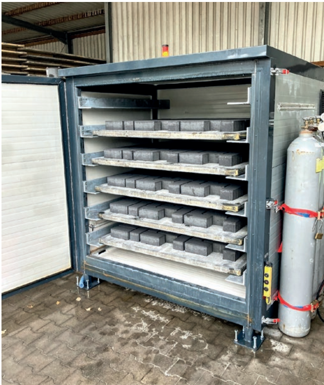
Podkłady produkcyjne ze świeżo wyprodukowanymi wyrobami betonowymi w TestCube.
