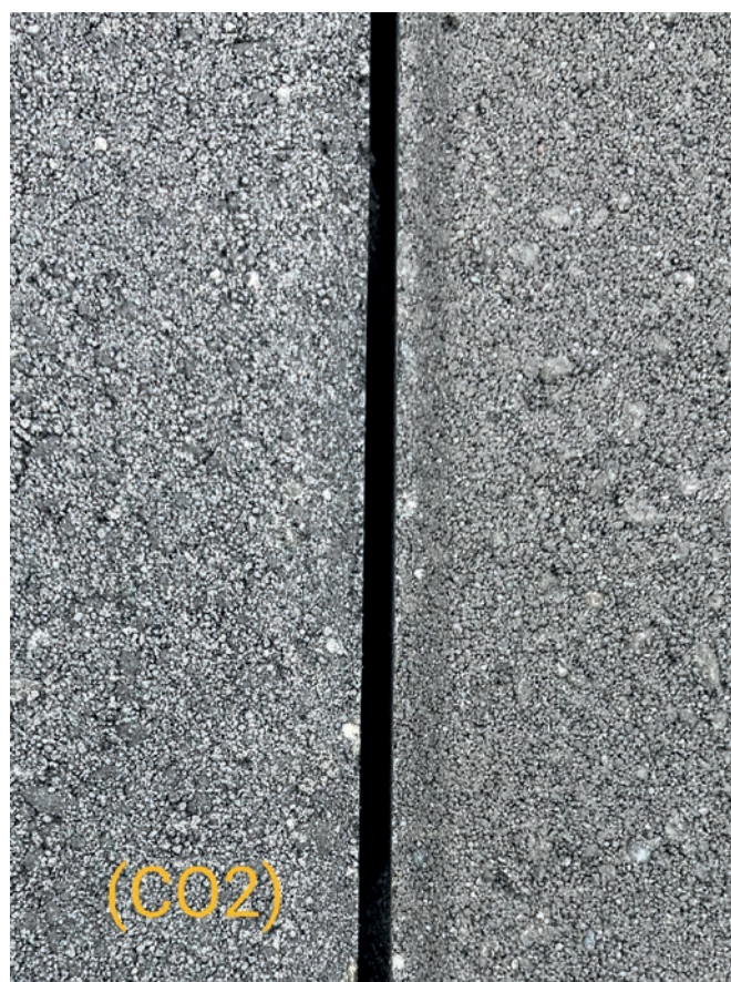
Element betonowy widziany od góry: z CO 2 po lewej i bez CO 2 po prawej stronie.
