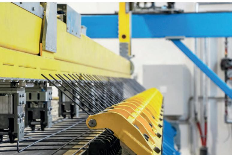
*Il sistema di piegatura completamente integrato agevola la lavorazione delle reti d'armatura realizzate in modo flessibile.*
