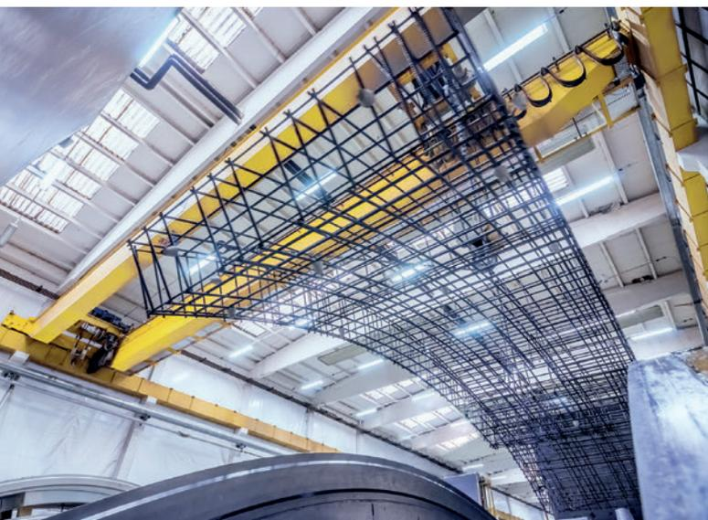
*Gabbie complete d'armatura per segmenti di gallerie possono essere realizzate in modo completamente automatico con le macchine costruite dal Progress Group.*
