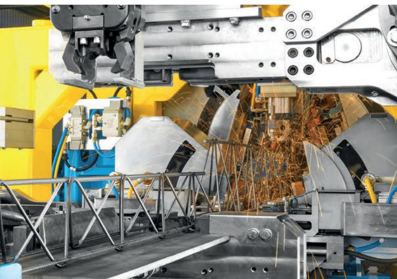
*La saldatrice di tralicci Versa consente una produzione just-in-time, flessibile, partendo dal coil, con cambio-altezze automatico.*
