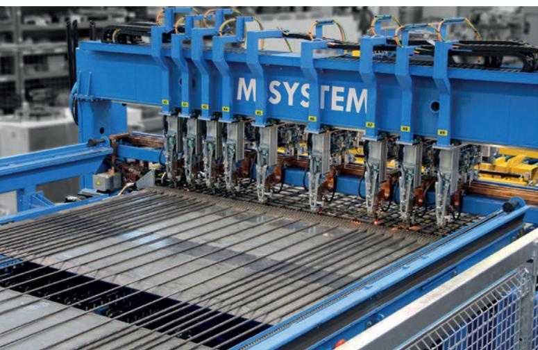
*L'impianto di saldatura reti M-System garantisce la produzione automatizzata di reti e gabbie d'armatura.*
