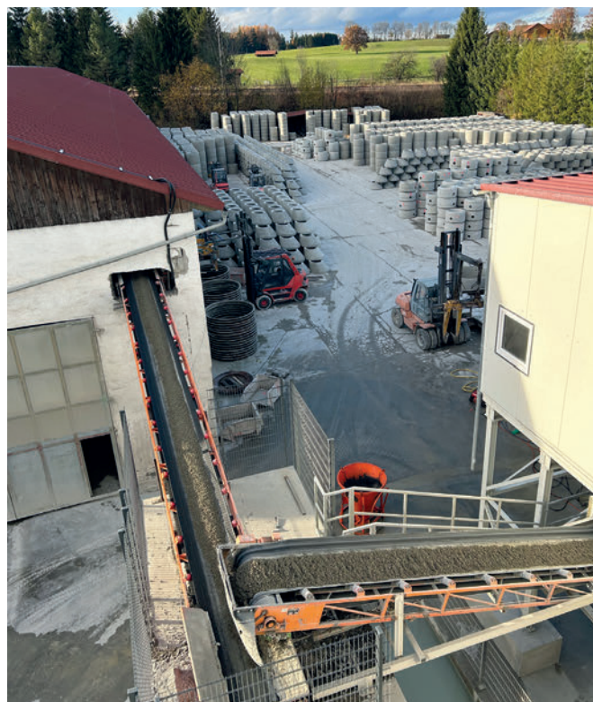
Il calcestruzzo a consistenza di terra umida arriva direttamente all'area di produzione, passando per i nastri trasportatori.
