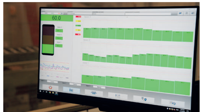
Misurazione laser della tolleranza in altezza ad ogni ciclo.
