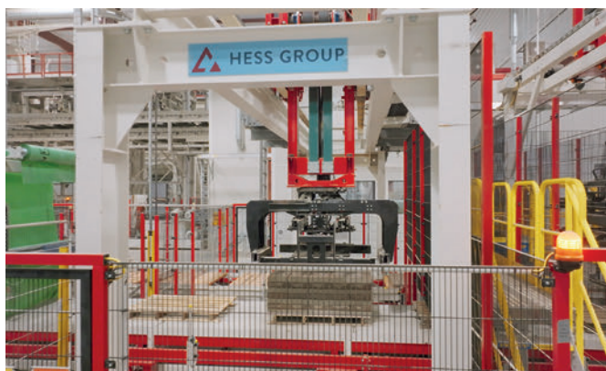
L'impacchettatrice Hess provvede al trasporto efficiente degli strati di prodotto dal pannello al pacchetto pronto per la spedizione.
