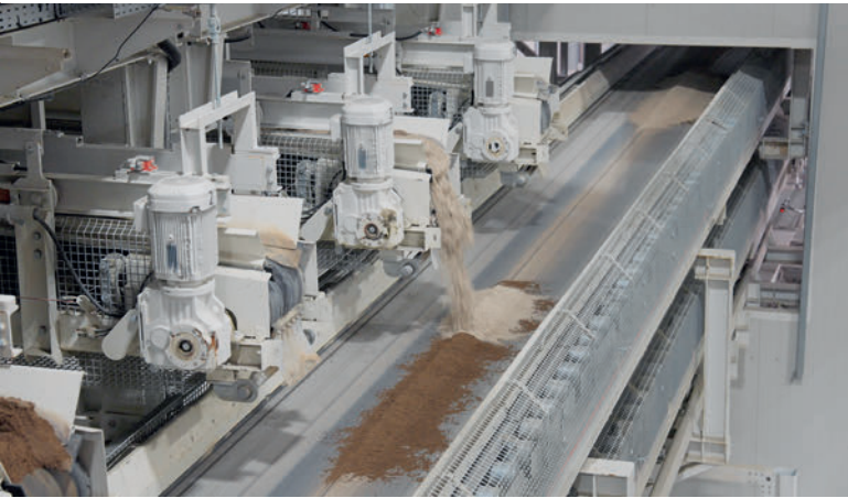
Nastro di alimentazione Quad programmato automaticamente per una miscela di colori costante.
