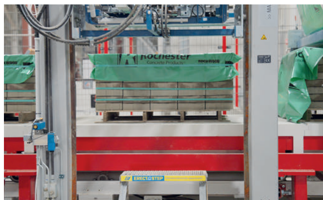
La reggiatura consente la circolazione dell'aria intorno ai prodotti e riduce al minimo i rifiuti d'imballaggio.
