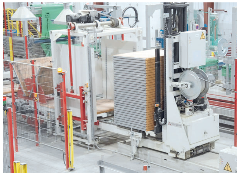
Il carrello portaforca raccoglie automaticamente i pannelli, li immagazzina e li trasporta a richiesta alla macchina.
