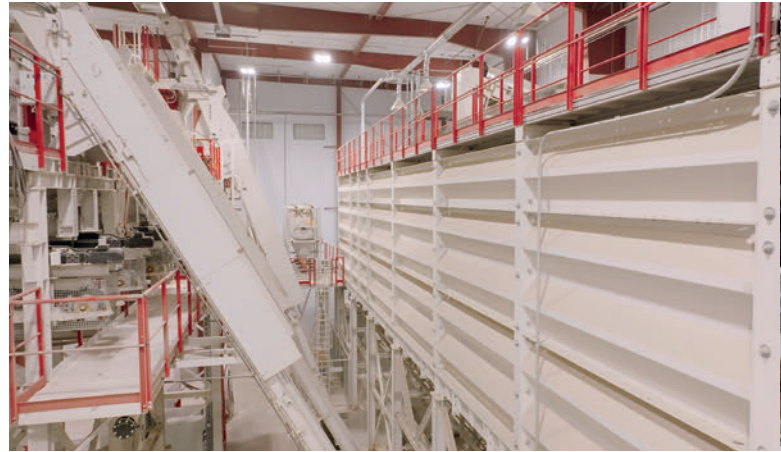
Il magazzino interno con una capacità di 660 t garantisce un'umidità costante dei componenti della miscela.
