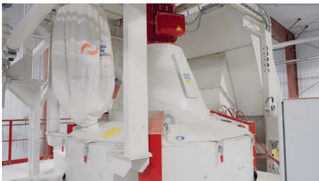
Miscelatore del calcestruzzo di secondo strato HPGM-3750 di Wiggert per un'alimentazione costante della blocchiera.
