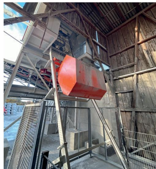
Élévateur alimenteur avec protection contre les chutes
