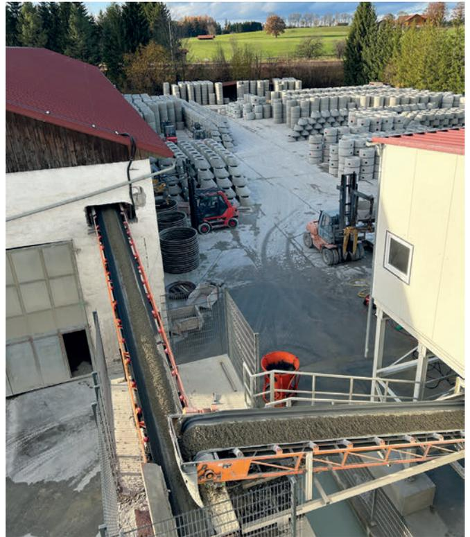
Le béton à consistance de terre humide s'écoule directement dans la zone de production via des bandes transporteuses.
