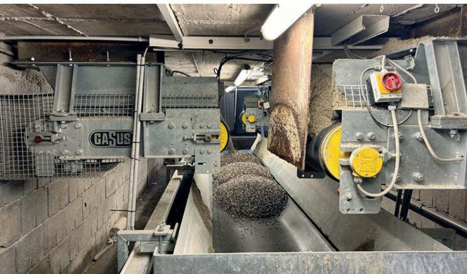
Les bandes doseuses existantes situées sous les différents silos de granulats procèdent au dosage sur la nouvelle bande de pesage.
