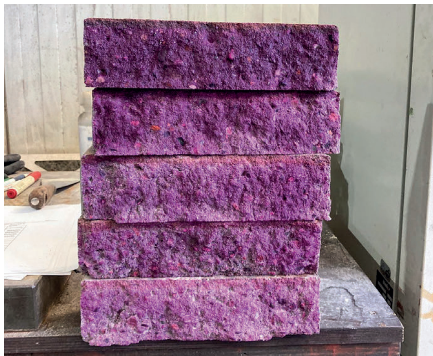
Pavés humidifiés de phénolphtaléine
