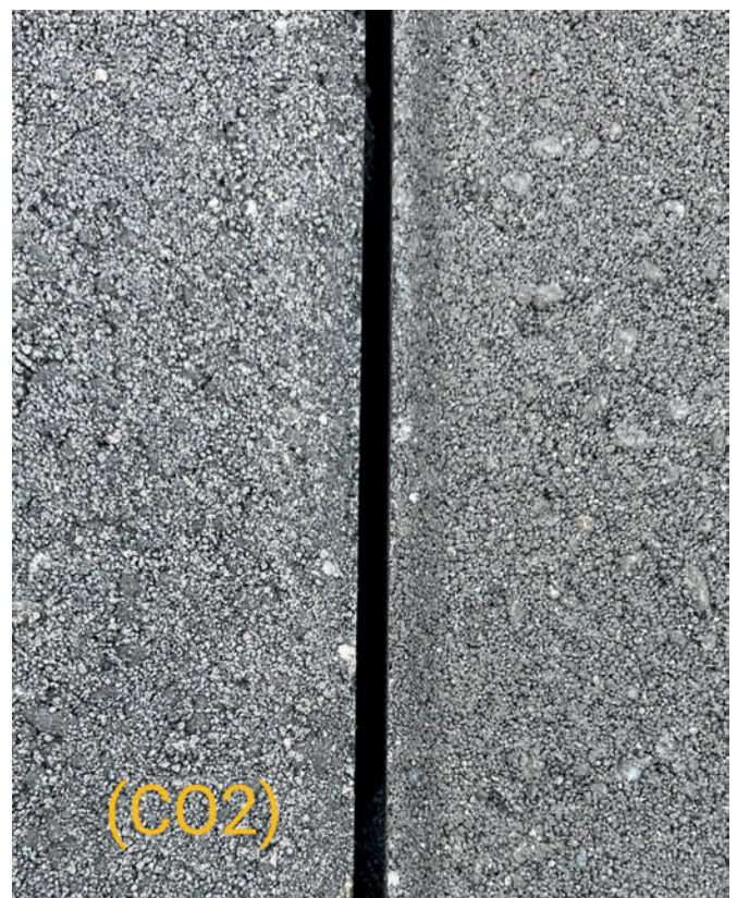
Pavé vu du dessus avec CO 2 à gauche et sans CO 2 à droite
