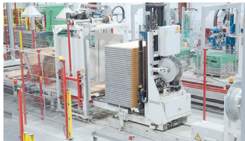
Le chariot tampon assure la collecte, le stockage et le transfert automatique des planches de production vers la machine - à la demande.
