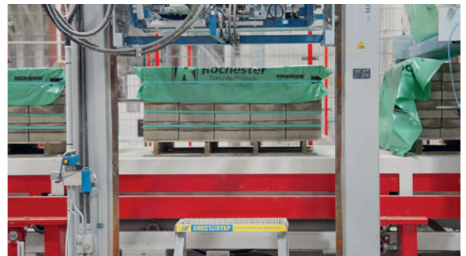
Le cerclage des paquets assure une bonne aération des produits et minimise les déchets d'emballage sur les chantiers.
