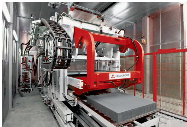
La presse vibrante Hess RH 2000-4 MVA offre une technologie avancée pour la production de blocs et pavés de grandes dimensions à la finition parfaite.
