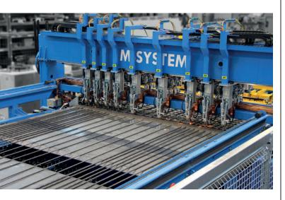
L'installation de soudage de treillis M-System garantit une production automatisée de treillis d'armature et de cages.
