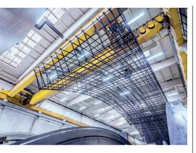
Des cages d'armature complètes pour segments de tunnel peuvent être fabriquées de manière entièrement automatique avec les machines de Progress Group.
