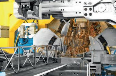
La soudeuse de raidisseurs Versa permet la production flexible et juste à temps de raidisseurs à partir de bobines, avec changement de hauteur automatique.
