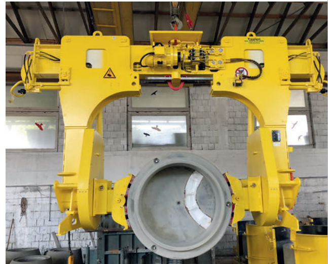
Se utiliza una pinza de volteo hidráulica para el desmoldar y girar de forma segura los componentes.
