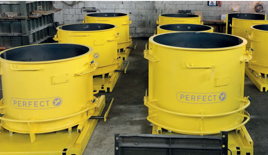
Desde 2019, Wegmann fabrica bases de pozo monolíticas con el procedimiento de fabricación Perfect de Schlüsselbauer Technology.
