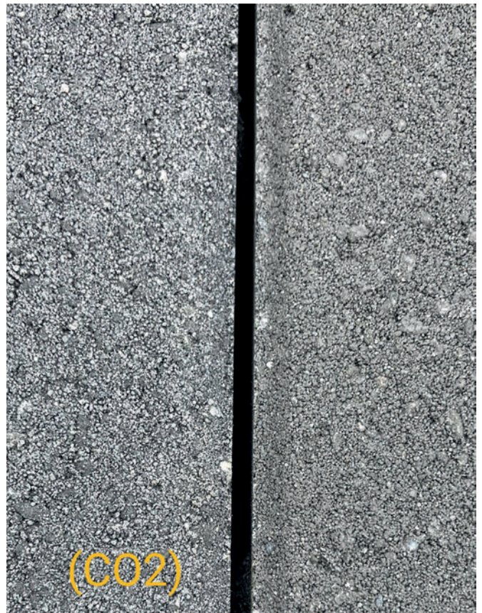
Adoquín desde arriba con \text{CO}_2 a la izquierda y sin \text{CO}_2 a la derecha
