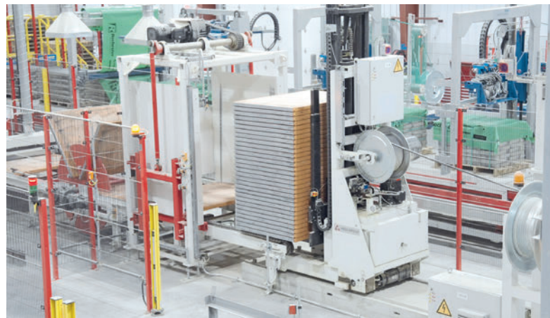
El carro multiforca recopila automáticamente las bandejas, las almacena y las transporta cuando la máquina las solicita
