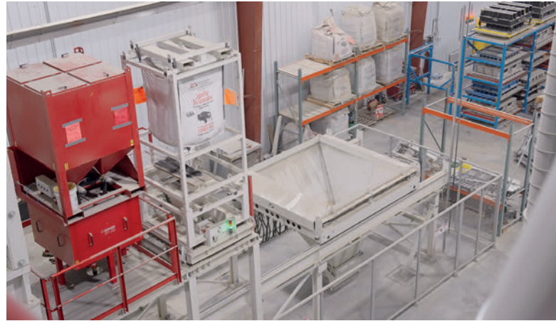
El microdosificador dosifica el pigmento para un diseño exacto de la coloración definitiva
