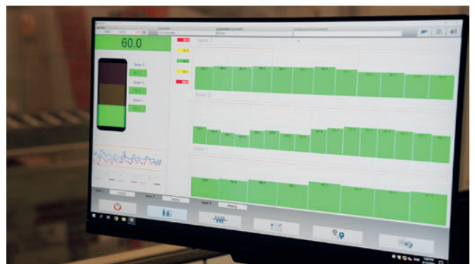
Medición láser de la tolerancia de la altura en cada ciclo
