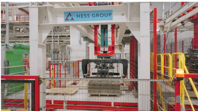
La empaquetadora de Hess ofrece un transporte eficiente de las planchas de productos desde la bandeja hasta el paquete listo para enviar
