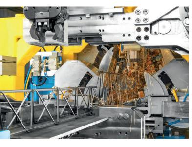
Die Gitterträgerschweißanlage Versa ermöglicht eine flexible Just-in-time-Produktion von Gitterträgern vom Coil mit automatischem Höhenwechsel.
