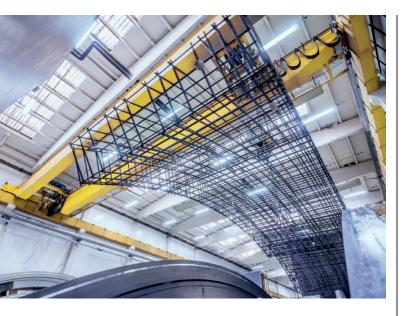
Komplette Bewehrungskörbe für Tunnelsegmente können mit den Maschinen aus dem Hause Progress Group vollautomatisch hergestellt werden.
