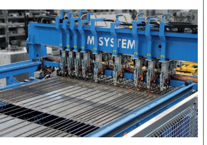
Die M-System Mattenschweißanlage garantiert die automatisierte Produktion von Bewehrungsmatten und Körben.
