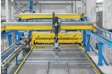
Der Schalungs- und Entschalroboter Form Master führt sämtliche Arbeitsschritte des Schalungsprozesses vollautomatisch aus.
