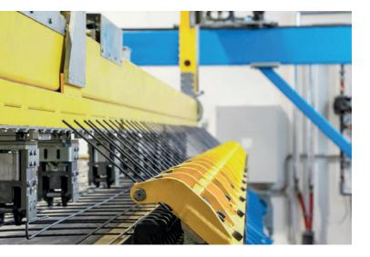
Das vollintegrierte Biegesystem erleichtert die Bearbeitung der flexibel hergestellten Bewehrungsmatten.
