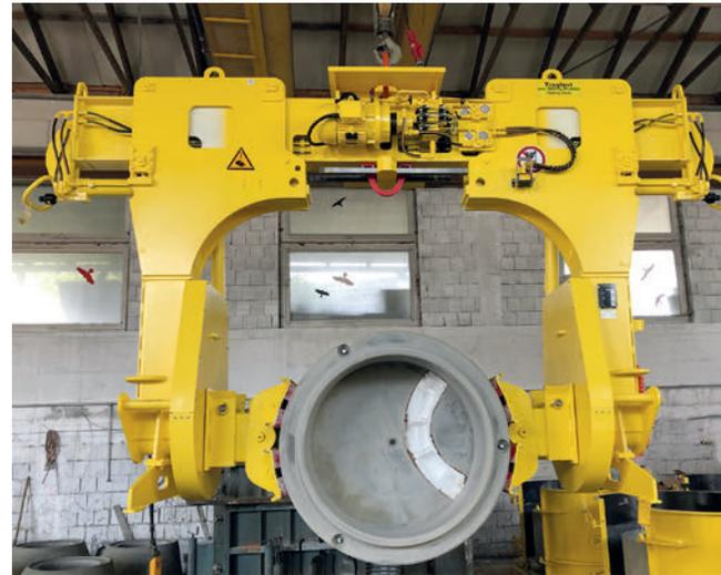
Für sicheres Entschalen und Wenden der Bauteile wird ein hydraulischer Wendegreifer eingesetzt.
