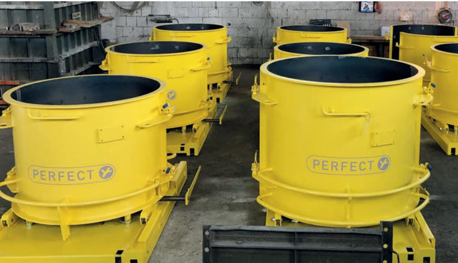
Seit 2019 fertigt Wegmann monolithische Schachtunterteile mit dem Perfect-Fertigungsverfahren von Schlüsselbauer Technology.
