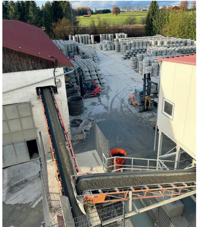
Erdfeuchter Beton läuft über Förderbänder direkt in den Produktionsbereich.
