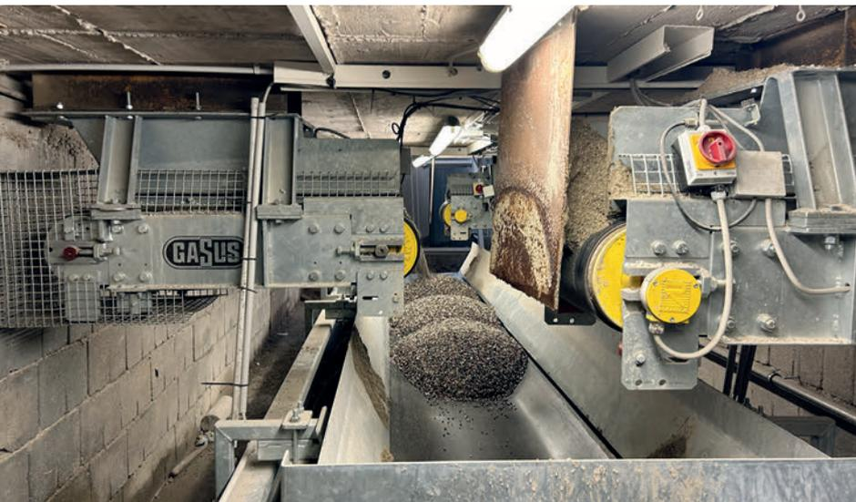
Die Dosierbänder unter den einzelnen Gesteinskörnungssilos aus dem Bestand dosieren auf das neue Wiegeband.
