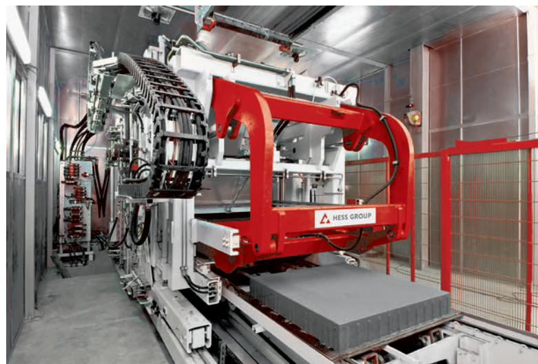
Hess Betonsteinmaschine RH 2000-4 MVA mit fortschrittlicher Technologie für größere Formate und hochwertige Oberflächen.
