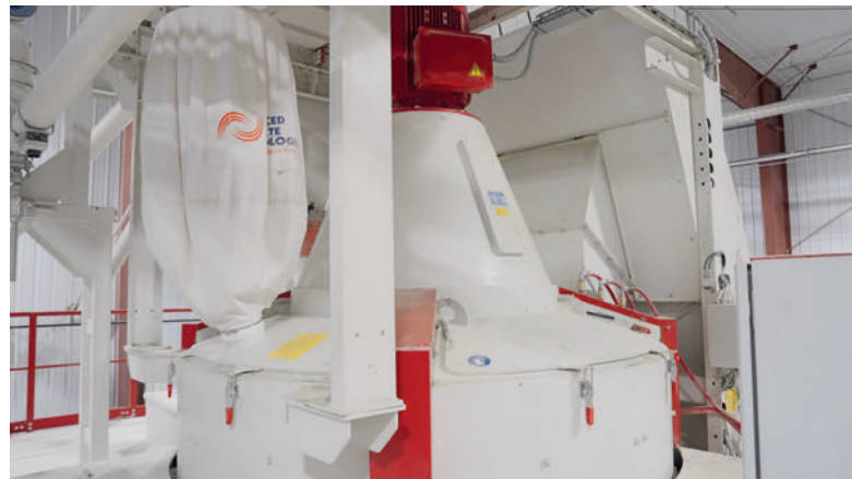
HPGM-3750-Kernbetonmischer von Wiggert für eine konstante Versorgung der Betonsteinmaschine. sorgt für eine gleichbleibende Feuchte der Mischungsbestandteile.
