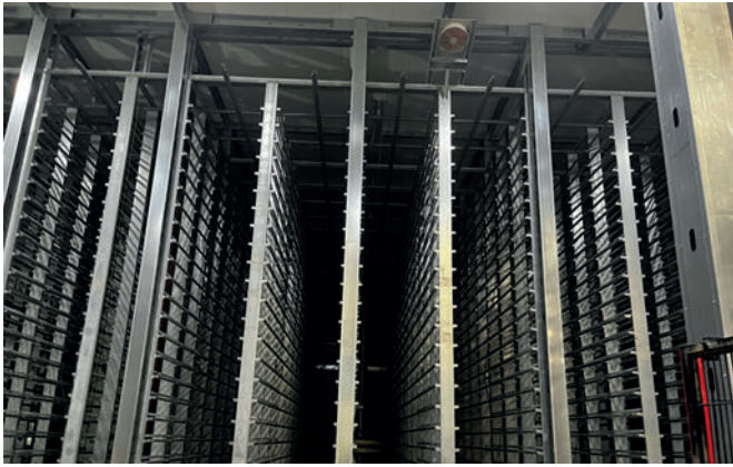
Regale in der Trockenkammer mit kontrollierter Temperatur und Feuchte
