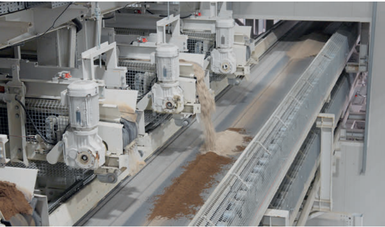
Automatisch programmierter Quad-Aufgabeförderer für eine gleichbleibende Farbmischung.
