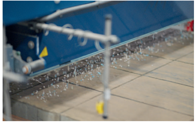
Der Granulatdosierer bestreut die Produkte mit einer Schutzschicht aus biologisch-abbaubarem Granulat und Feuchte
