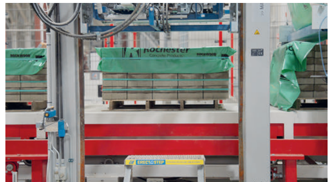
Die Umreifung erlaubt eine Luftzirkulation um die Produkte und minimiert den Verpackungsabfall.
