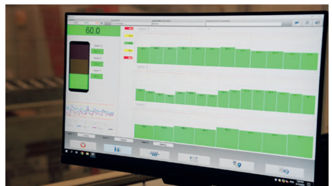
Lasermessung der Höhentoleranz in jedem Zyklus.
