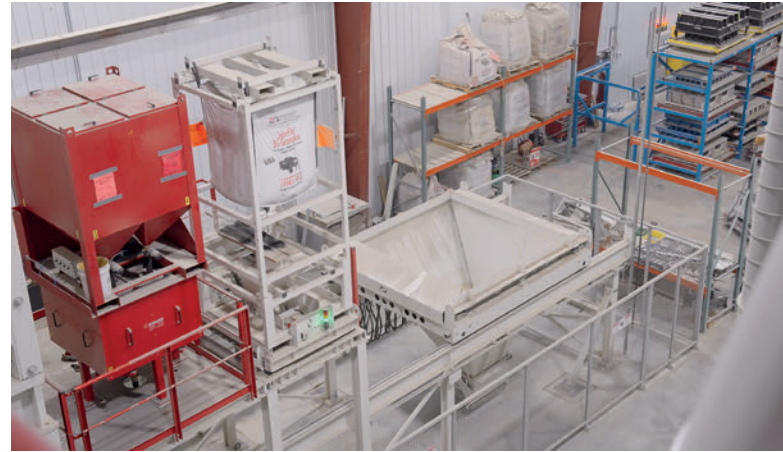
Der Mikrodosierer gibt die Farbe für eine genaue Bemessung der endgültigen Farbgebung grammweise ab.
