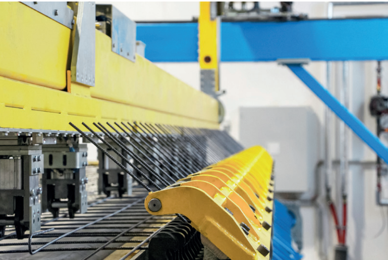
全集成的弯曲系统简化了灵活制造钢筋网的加工
