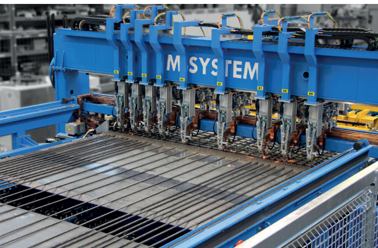
M-System 网格焊接设备保证了钢筋网和笼子的自动化生产
