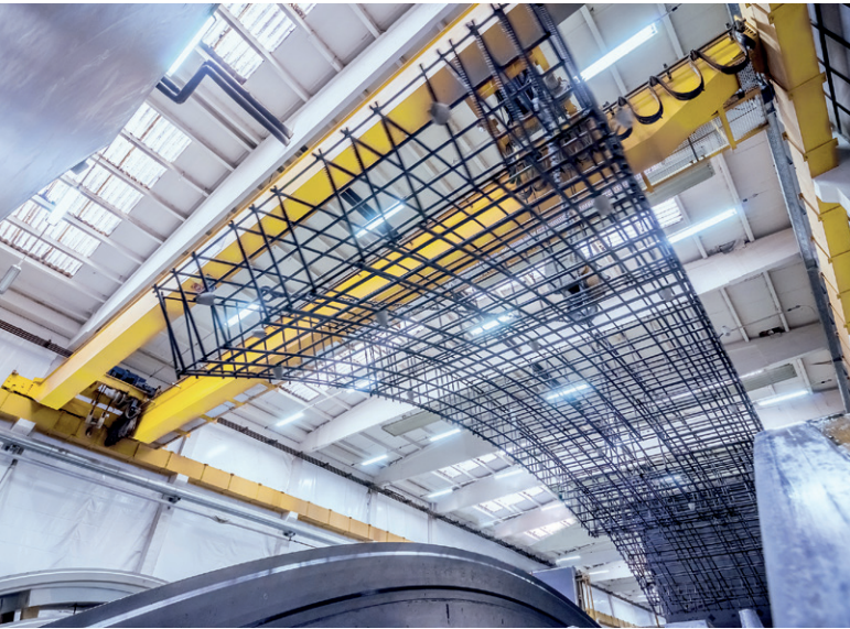
使用 Progress Group 公司的设备，可以全自动化生产隧道内的完整钢筋笼
