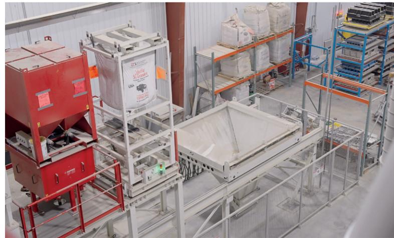
微量计量仪按克提供颜色，以便准确测量最终的颜色
