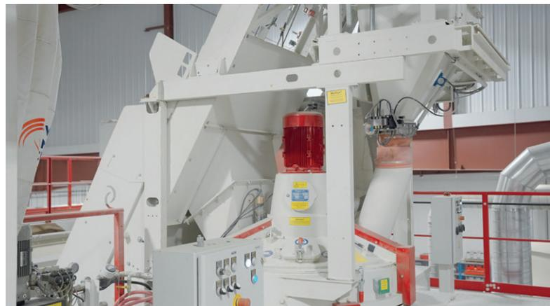
Wiggert 的 HPGM-375 型预拌混凝土搅拌机
