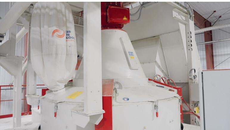
Wiggert 的 HPGM-375 型核心混凝土搅拌机，确保混凝土砖机的持续供应
