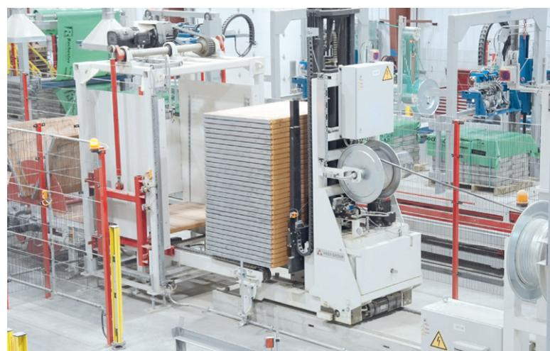
板式车组自动收集、存储生产栈板，并在需要时将其运送到机器中
