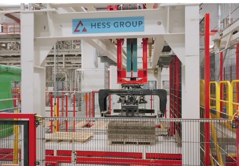
海斯包装机确保将产品有效地从生产栈板移到准备好发运的包装上
